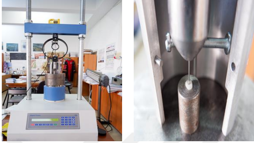
Resim 5. Universal test cihazı (ELE triaxial universal test makinesi; ELE international, Bedfordshire, İngiltere) ve test cihazına yerleştirilen dentin diskine kuvvet uygulanması
