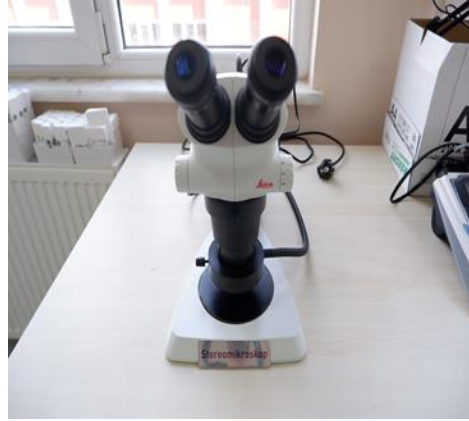
Resim 6. Push-out testinden sonra oluşan kırık tiplerinin steromikroskop (Leica S4E, Leica microsystems, Wetzlar, Almanya) altında incelenmesi
