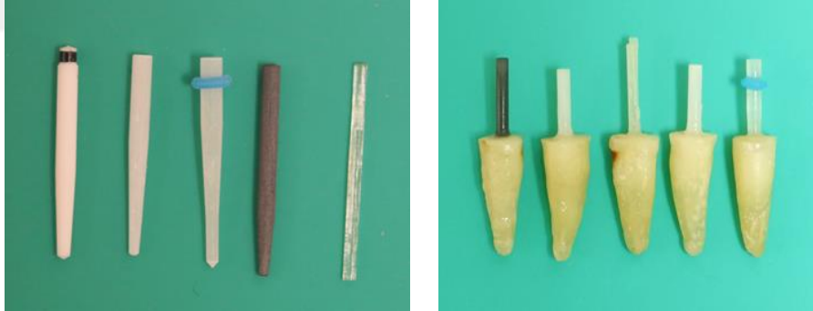
Resim 3. Çalışmamızda kullanılan fiber postlar ve hazırlanan dişlere simante edilmeleri
