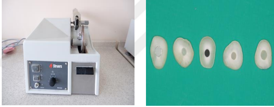
Resim 4. Milimetrik kesit alma cihazı (Struers A/S, DK 2750, Ballerup, Danimarka) ve fiber post simante edilen dişlerden alınan kesitler
