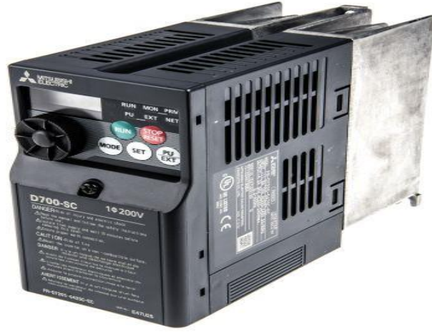
Şekil 5.7. Mitsubishi marka 240V-320V frekans inverteri
