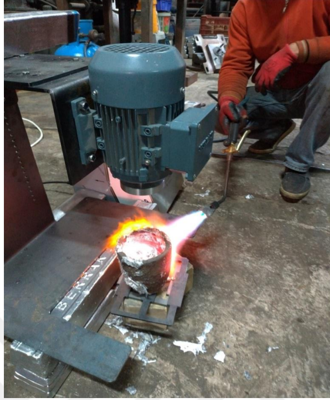
Şekil 5.9. Etial145-SiC kompozitin vorteks cihazında karıştırılması
