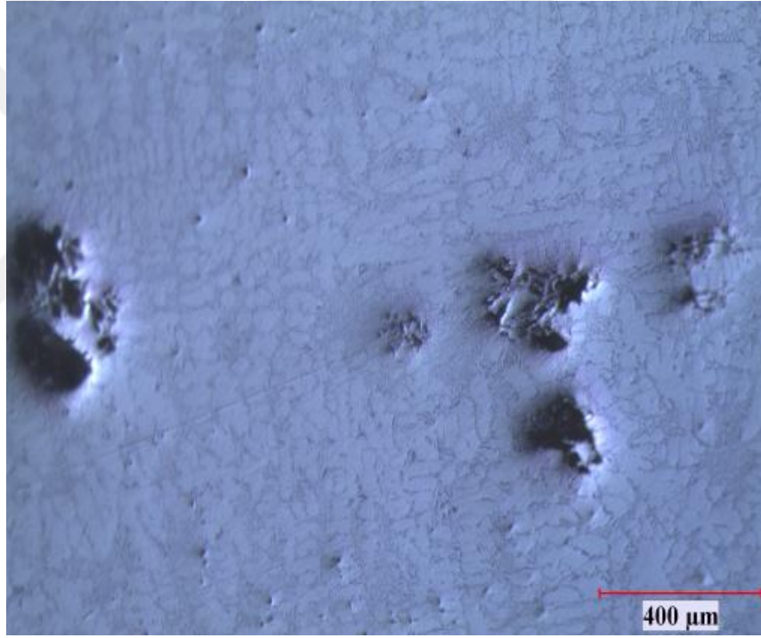
Şekil 6.1. Etial145-%5 SiC katkılı kompozitin mikro yapısı
