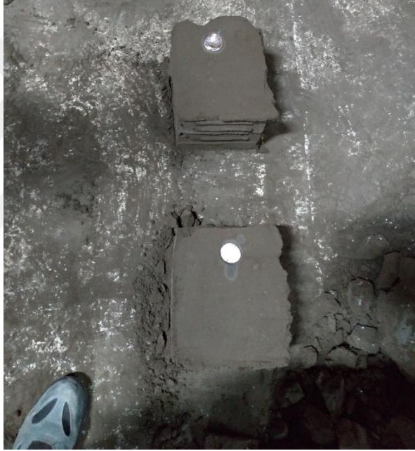
Şekil 5.10. Dökülmüş Etial145-SiC kompozitlerinin soğutulması aşaması
