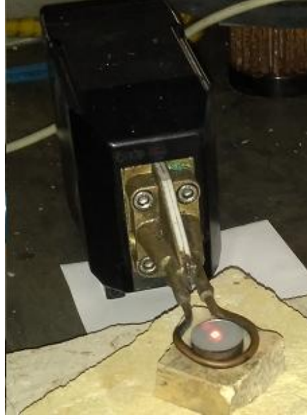
Şekil 3.13. İndüksiyon bobini ve içindeki numune.
