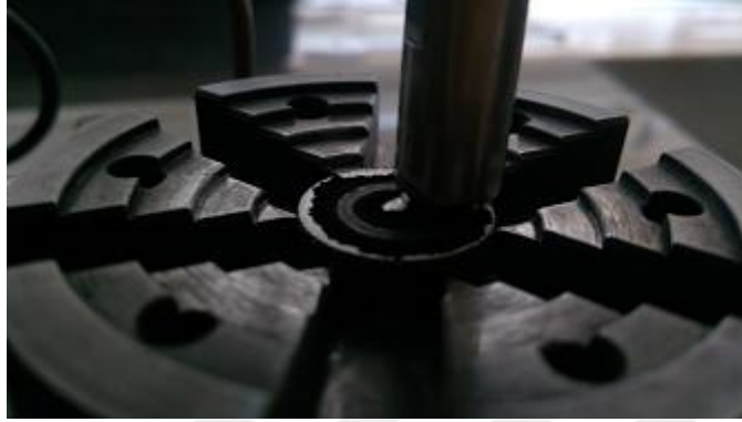
Şekil 4.11. Aşınma sonrası oluşan iz ve aşınma birikintileri.
