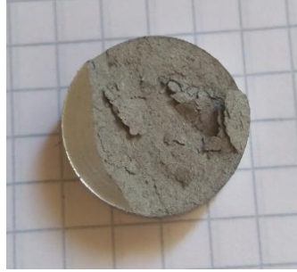
Şekil 4.4. Sinterleme esnasında hasar gören numune.
