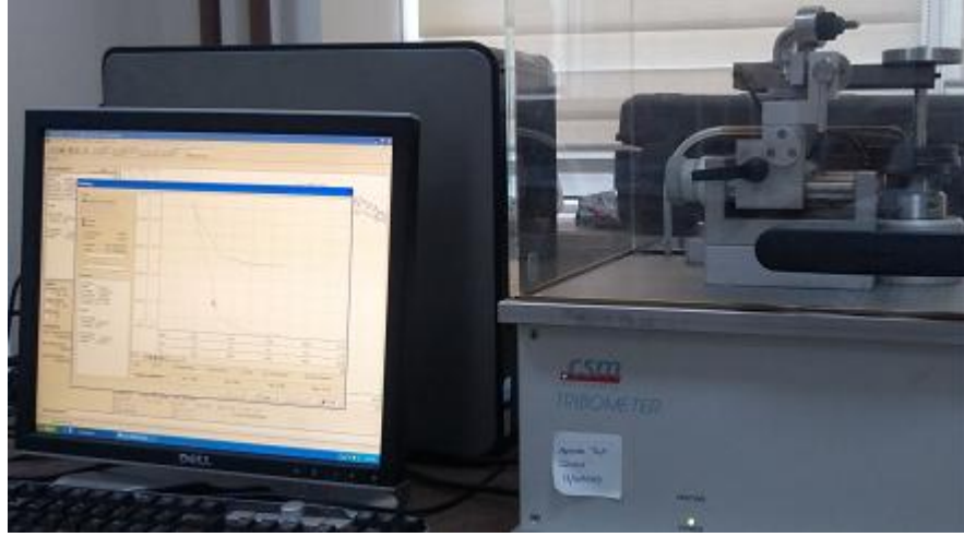
Şekil 3.16. Aşınma deneyleri için kullanılan tribometre.
