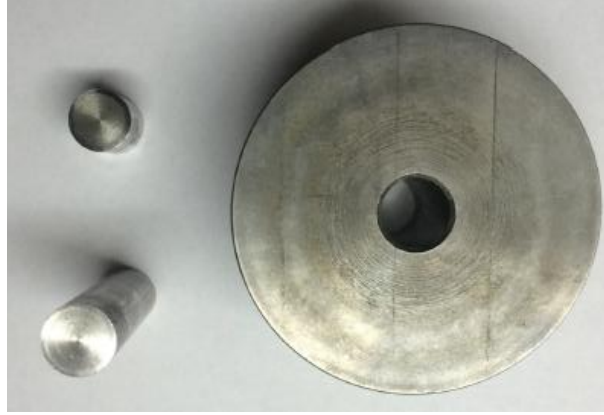
Şekil 3.11. Tozlara şekil verdiğimiz kalıp ve pimler.
