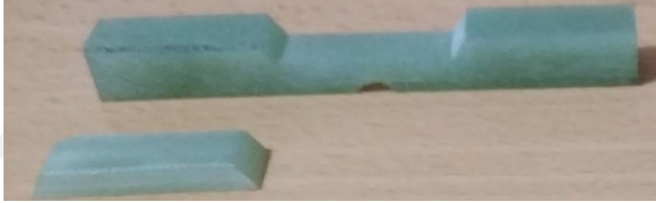
Şekil.3.27. 60° Dolgu Yama Charpy Darbe Deney Numunesi
