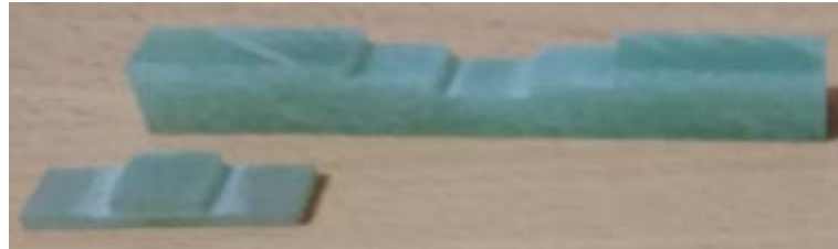
Şekil.3.15. 10x30 Basamaklı Yama Üç Nokta Eğme Deney Numunesi
