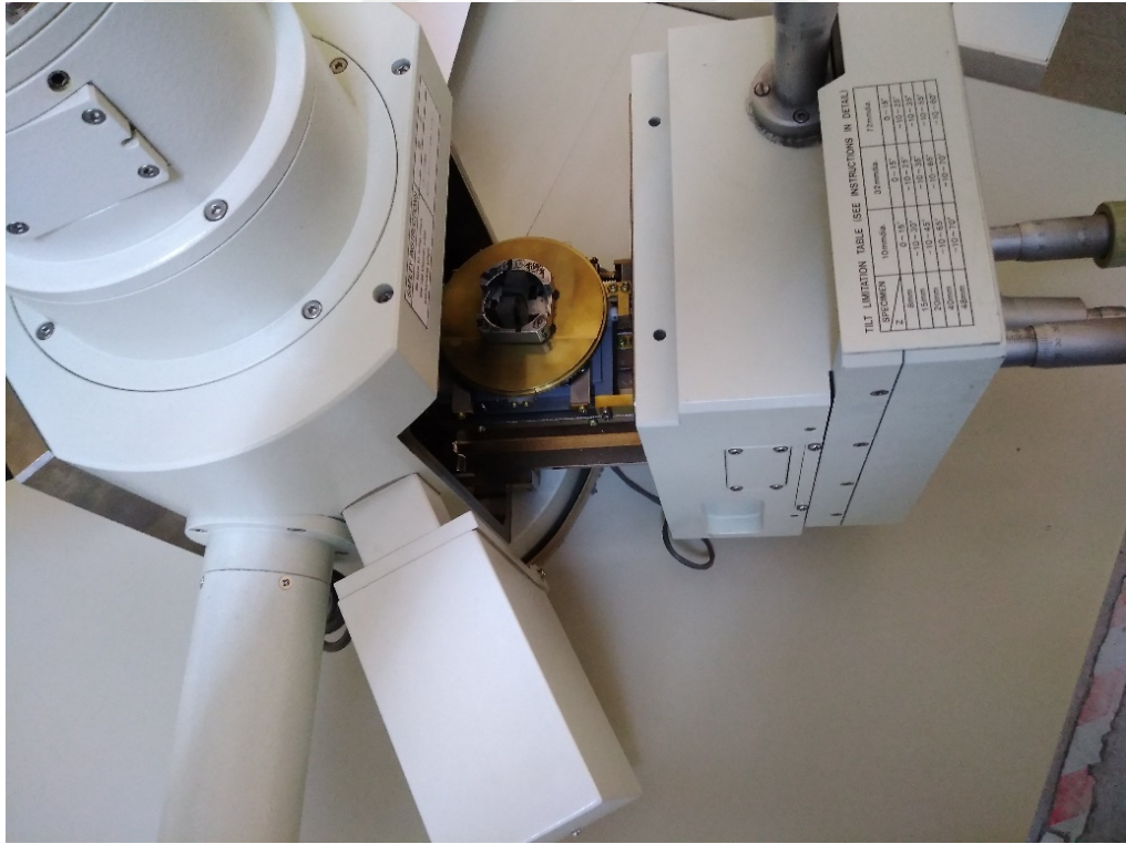
Şekil.3.32. SEM Cihazına Numune Yerleşimi
