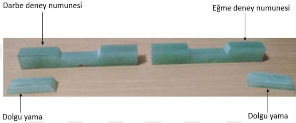
Şekil.3.39. Talaşlı İmalat Sonrası Numune ve Yama
