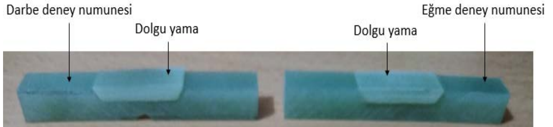
Şekil.3.40. Numune ile Yamanın Birleşimi
