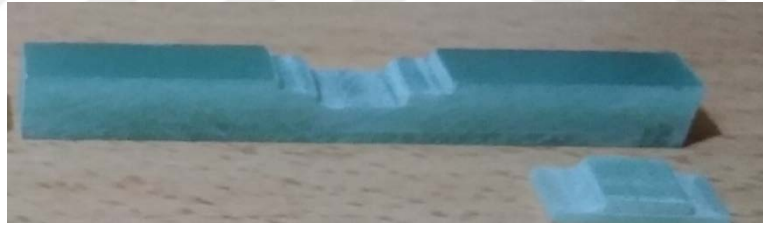
Şekil.3.14. 10x20 Basamaklı Yama Üç Nokta Eğme Deney Numunesi
