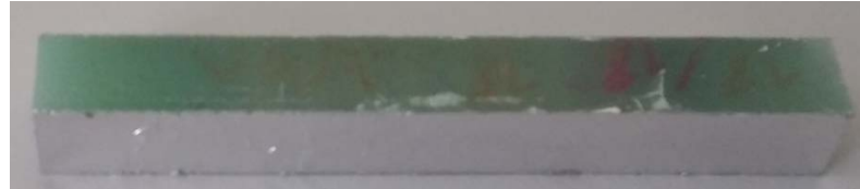
Şekil.3.20. Tıkama Metodu ve Al Bant Eğme Deney Numunesi
