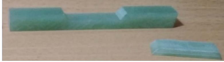
Şekil.3.18. 60° Dolgu Yama Üç Nokta Eğme Deney Numunesi
