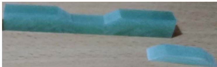
Şekil.3.16. 30° Dolgu Yama Üç Nokta Eğme Deney Numunesi
