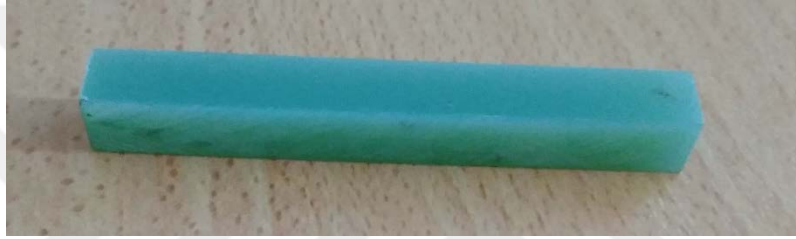
Şekil.3.13. Dolu (Hasarsız) Üç Nokta Eğme Deney Numunesi
