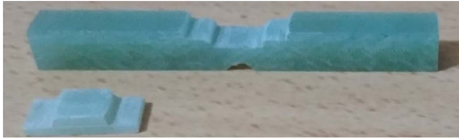
Şekil.3.23. 10x20 Basamaklı Yama Charpy Darbe Deney Numunesi
