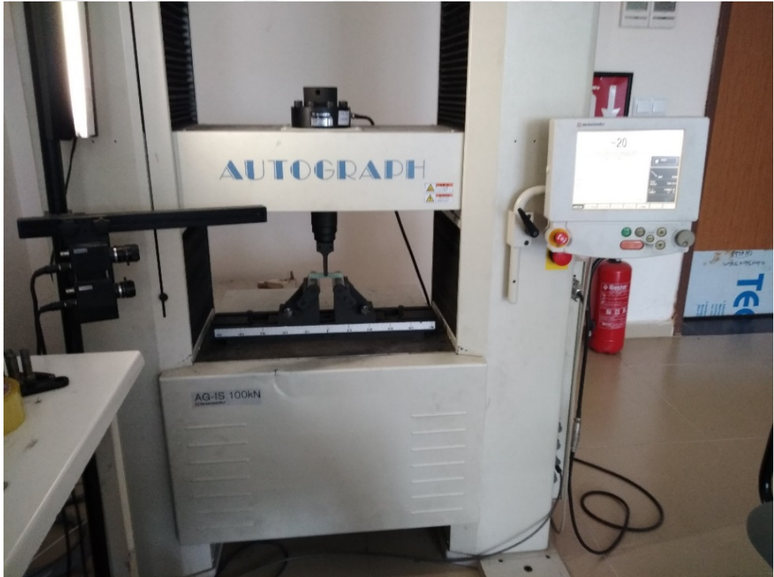
Şekil.3.4. Shimadzu AG-IS ( 100 kN ) - (Çekme-Üç Nokta Eğme)
