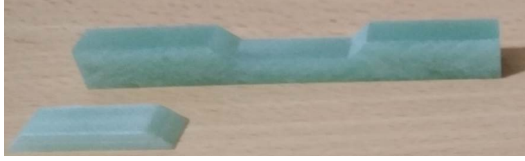
Şekil.3.17. 45° Dolgu Yama Üç Nokta Eğme Deney Numunesi
