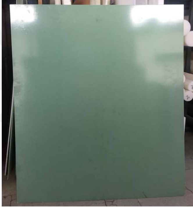
Şekil.3.2. İşlenmemiş Hammadde (Cam Elyafı Epoksi Fiber)
