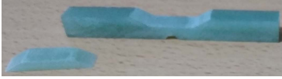
Şekil.3.25. 30° Dolgu Yama Charpy Darbe Deney Numunesi
