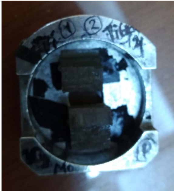
Şekil.3.30. Numunelerin Kaplama Cihazına Yerleşimi
