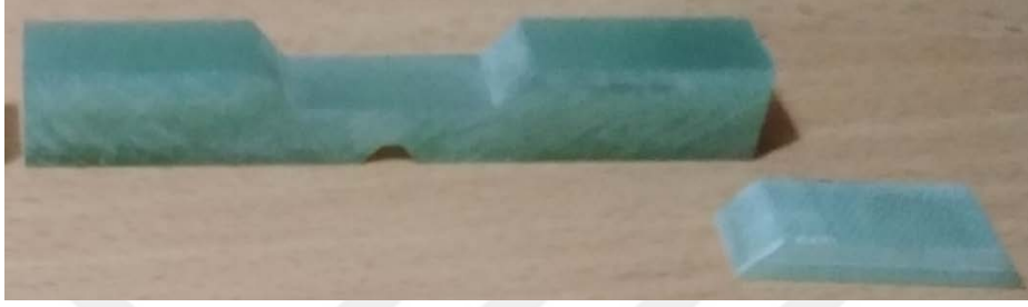
Şekil.3.26. 45° Dolgu Yama Charpy Darbe Deney Numunesi
