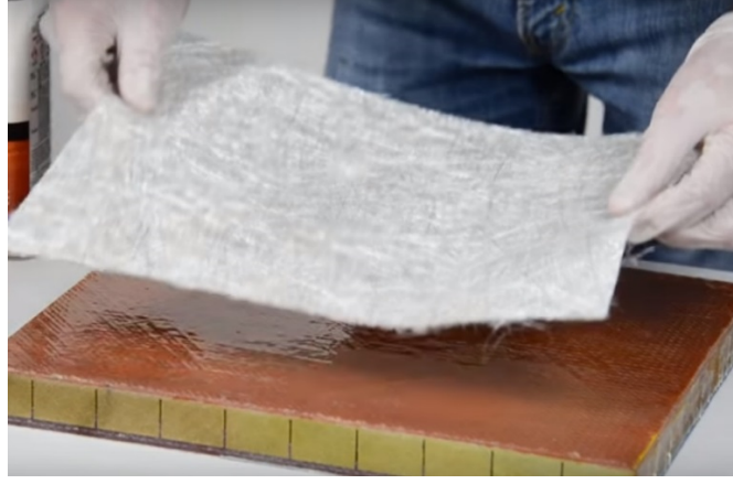
Şekil.3.1. Cam Elyafı Epoksi Fiber Üretimi
