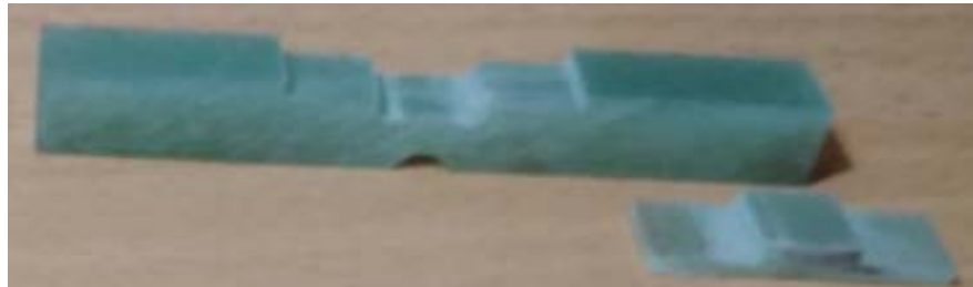
Şekil.3.24. 10x30 Basamaklı Yama Charpy Darbe Deney Numunesi
