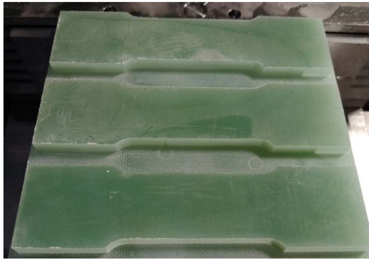
Şekil. 3.34. CNC Freze ile Numunelerin Hazırlanması
