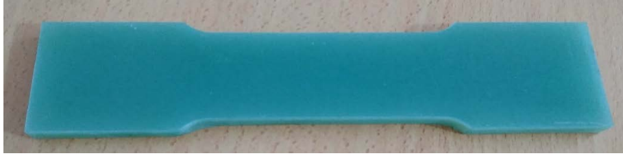
Şekil.3.7. Dolu (Hasarsız) Çekme Deney Numunesi
