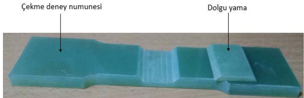
Şekil.3.37. Talaşlı İmalat Sonrası Numune ve Yama
