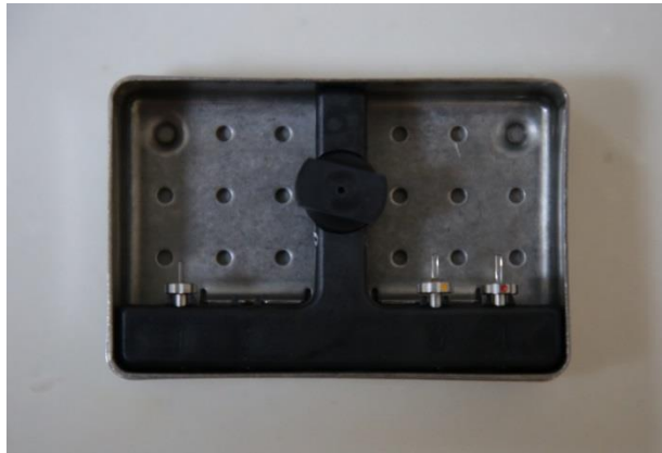
Resim 7. Diagnodent Pen 2190 (Kavo, Biberach, Almanya) cihazına ait Tip 1, Tip 2 prob ve seramik kalibrasyon aparatı
