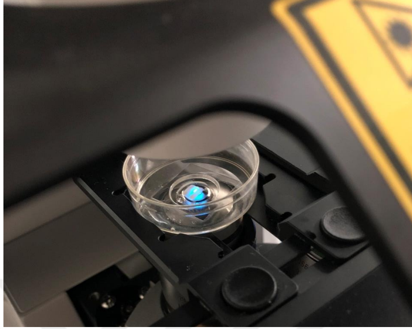
Resim 14. KLTM ye yerleştirilen dairesel petri içindeki dentin bloğunun kanal boşluğuna odaklanmış lazer ışını
