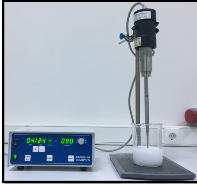
Şekil 3.1. Ultrasonik karıştırıcıda DYPE ve kalsiyum karbonatın karıştırılma işlemi
