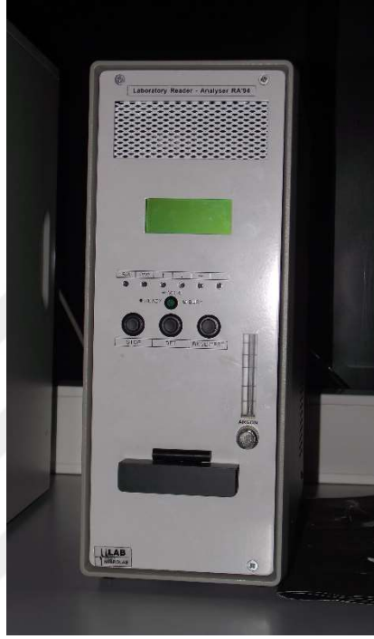
Şekil 3.1. TL ışınma eğrilerinin kaydedildiği MicroLab RA94 model TLD okuyucu.
