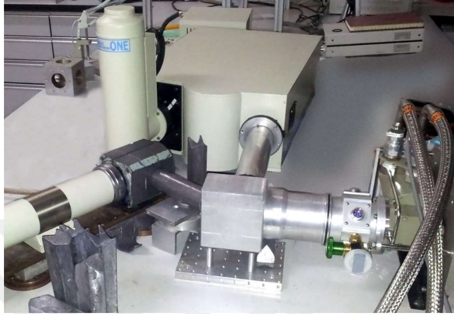
Şekil 3.2. Radyolüminesans ölçümlerinin alındığı sistem.
