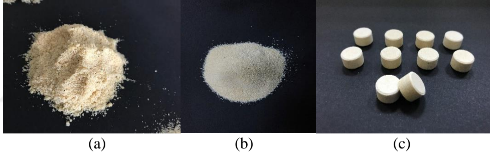
Şekil 3. 4. a) Çeşme suyuyla muamele ile elde edilen balık kılçığı tozu, (b) Kimyasal muamele ile (NaOH, Sodyum Hipoklorit, Sitrik asit) balık kılçığından elde edilen toz, (c) Kimyasal muamele ile (NaOH, Sodyum Hipoklorit, Sitrik asit) elde edilen balık kılçığı tozundan üretilen tabletler
