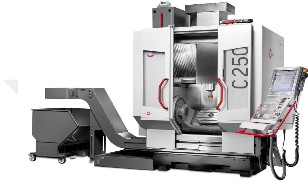
Şekil 6.6 CNC 5 eksen tezgahı (HERMLE C250).
