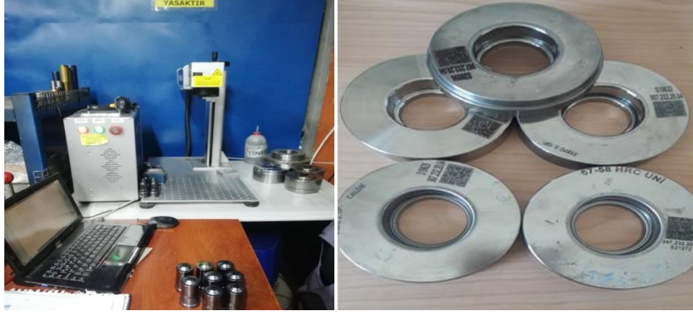
Şekil 3.13. Lazer markalama ve QR kodlama
