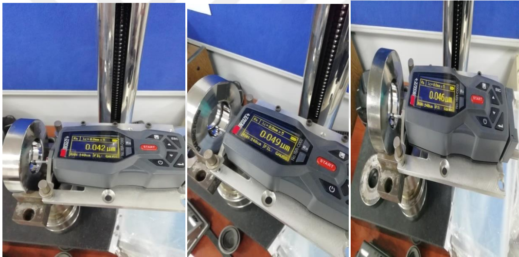
Şekil 4.7. Çekirdek kalıbına uygulanan yüzey pürüzlülük kontrolü
