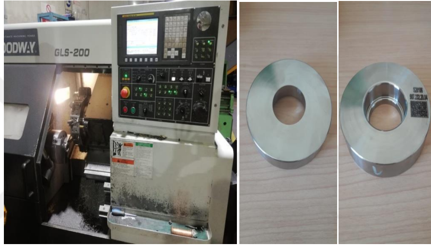
Şekil 3.9. CNC torna tezgahı ve işlenmiş çekirdek kalıbı
