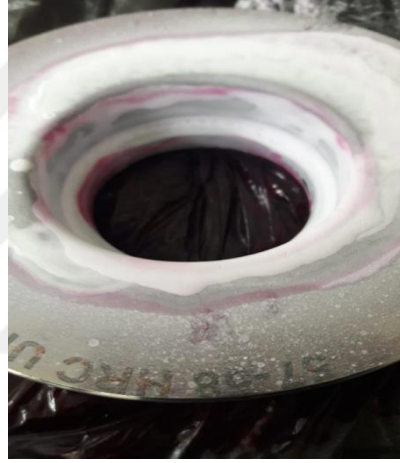
Şekil 4.10. Unimax malzemeden imal edilen kalıp çeliğine penetrant uygulaması
