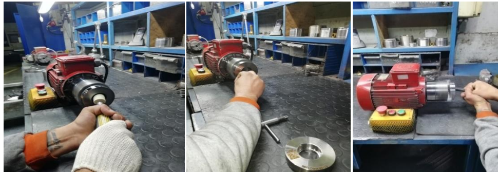
Şekil 3.10. Kalıplara uygulanan parlatma işlemi
