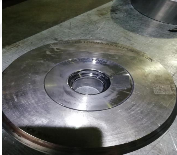
Şekil 3.12. Parlatılmış ve montajlanmış alt grup kalıp seti
