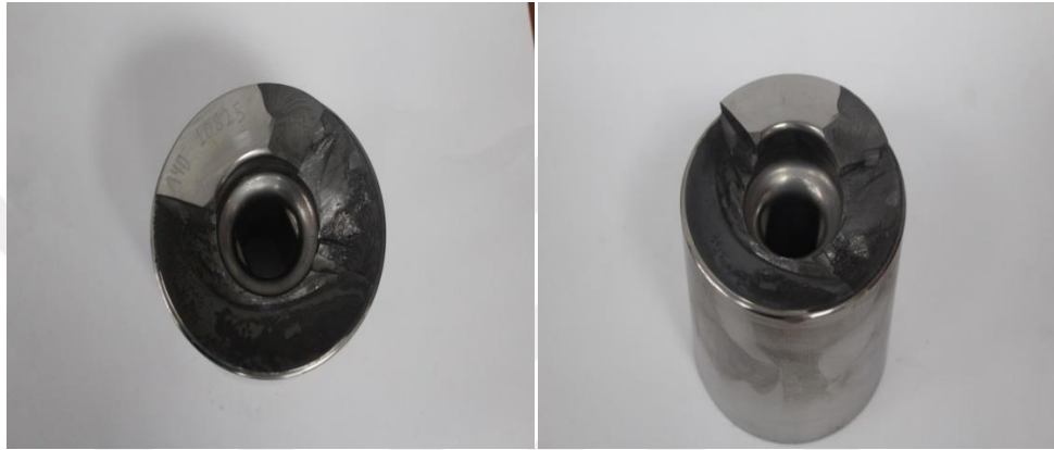
Şekil 2.35. Yorulma kalıp hasar örneği
