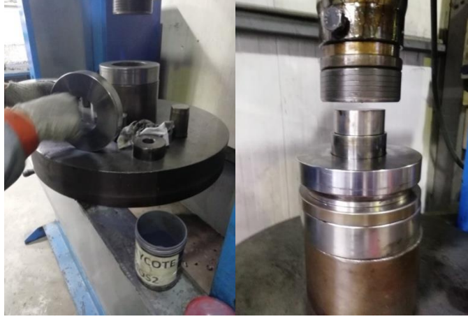
Şekil 3.11. Hidrolik preste kalıp montajı
