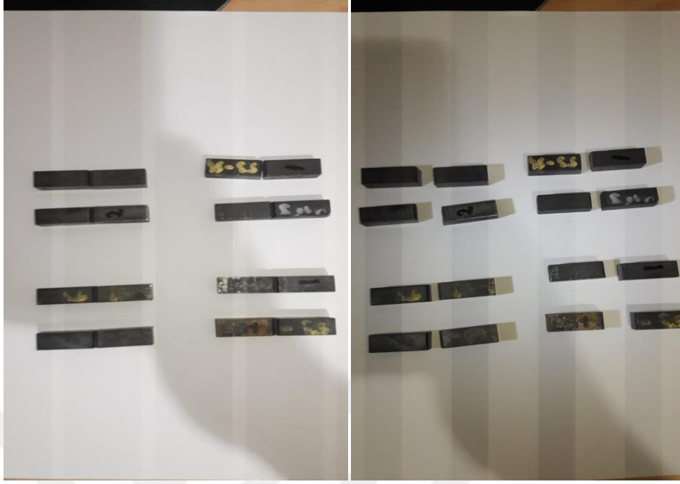
Şekil 4.8. Çentik darbe testi uygulanmış test numuneleri
