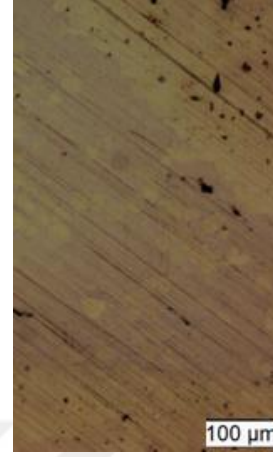
Şekil 4.40. 4 no.lu dolgu teli kullanılan bağlantı OM mikroyapısı genel görünümü
