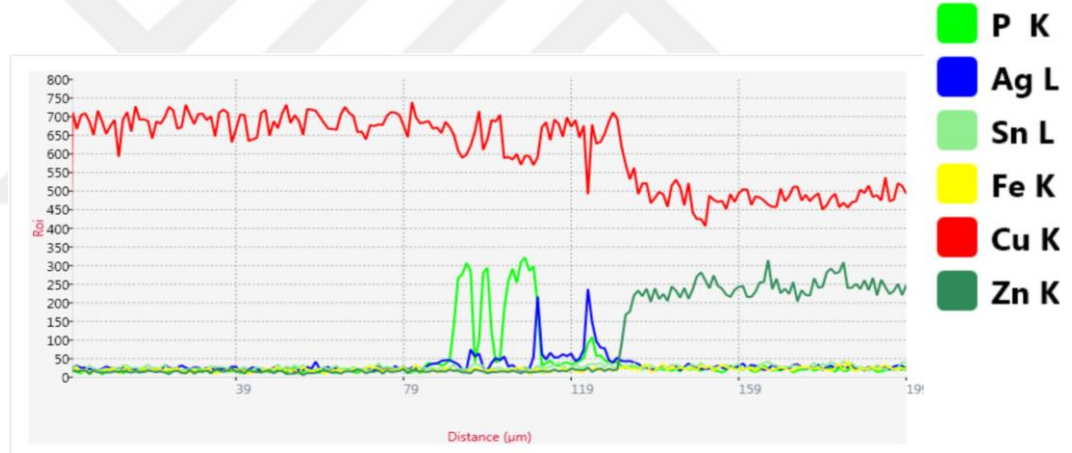
Şekil 4.12. BCU-P-3 (2 no.lu) dolgu teli kullanılan bağlantıda çizgi analizi
