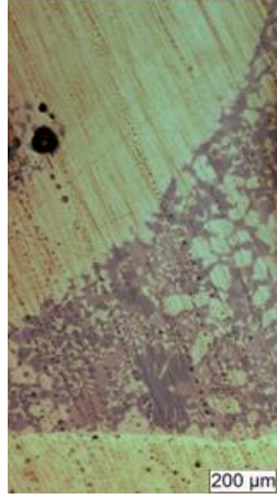
Şekil 4.13. 3 no.lu dolgu teli kullanılan bağlantı ve arayüzey OM mikroyapısı genel görünümü
