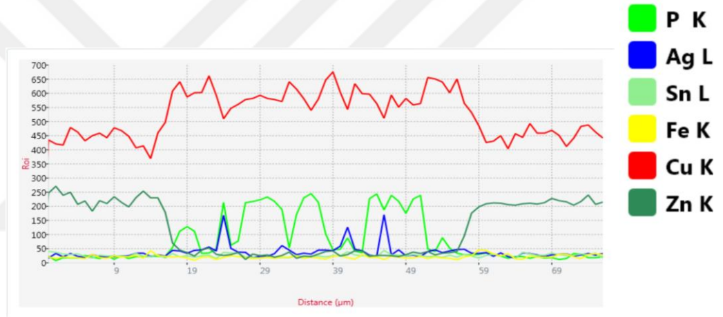
Şekil 4.34. 2 no.lu dolgu teli kullanılan bağlantıda çizgi tarama
