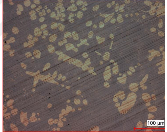
Şekil 4.28. 1 no.lu dolgu teli kullanılan bağlantı OM mikroyapısı genel görünümü
