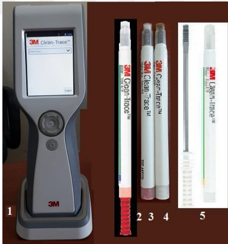
Şekil 3.1. ATP Ölçümü İçin Kullanılan Lüminometre (1) ve Probları (2 ve 3 Toplam ATP, 4 ve 5 Serbest ATP Probu).
