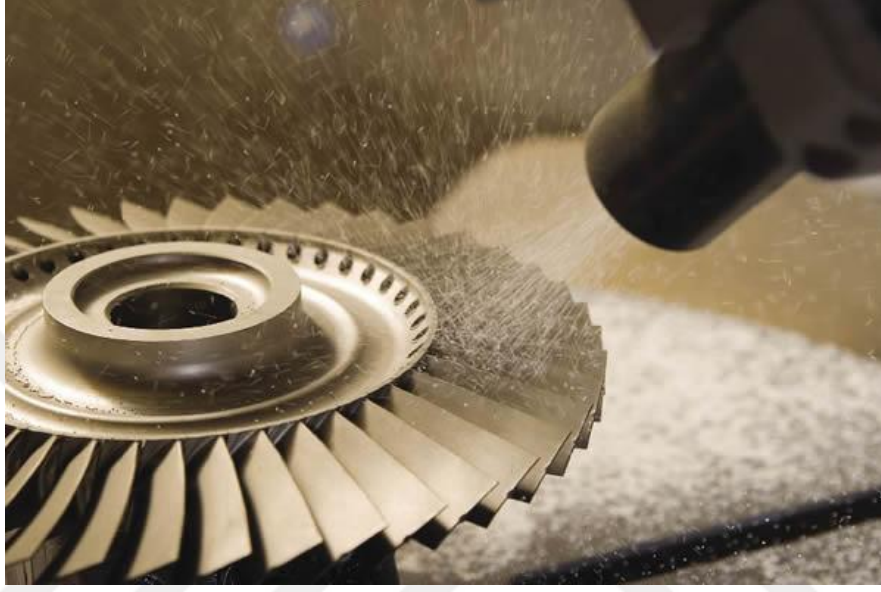
Şekil 2.13: Bilyalı dövme işlemi uygulanan bir türbin pervanesi [5]
