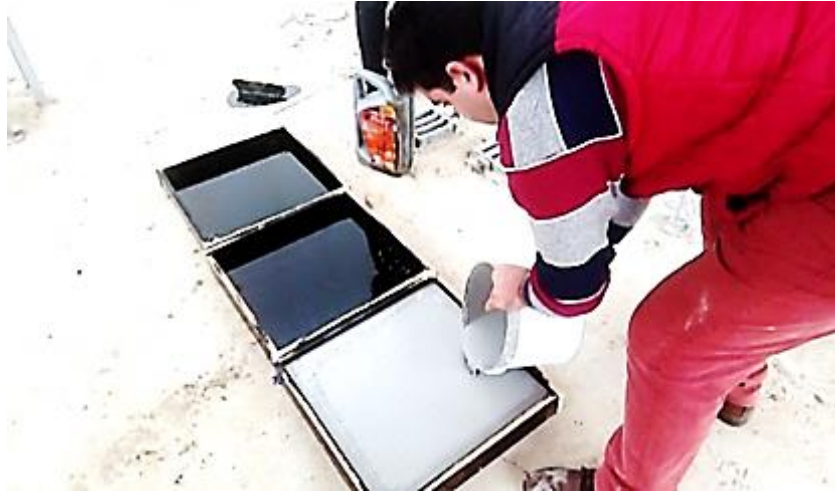
Şekil 5.2. Grout harçlarının kalıplara dökülmesi
