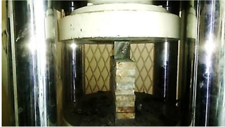
Şekil 5.6. S1, S2 ve S3 numunelerinin dayanım değerlerinin belirlenmesi
