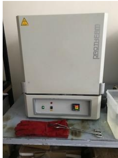
Şekil 4.2. 530 °C' de çözeltilme işleminin yapıldığı fırın
