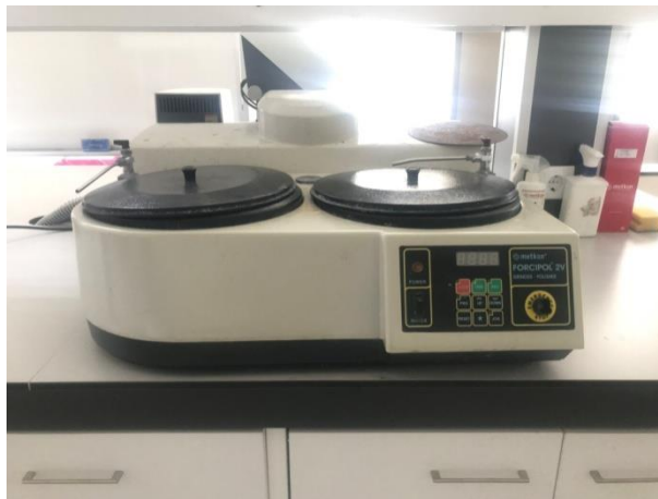
Şekil 4.4. Zımparalama ve parlatma cihazı
