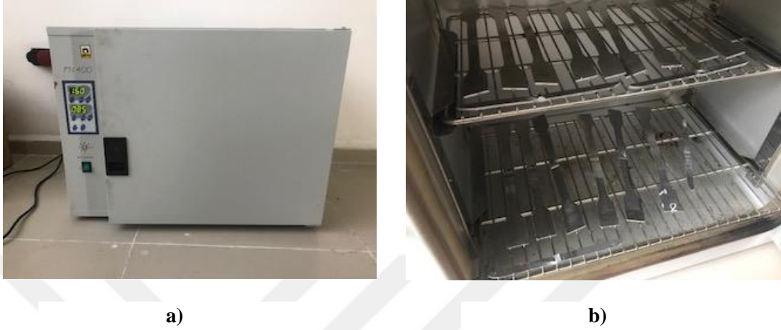
Şekil 4.3. CMT ile birleştirilmiş numunelerin 160 °C’de 18 saat yaşlandırma ısı işlemi
