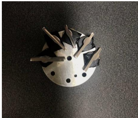
Şekil 4.10. Numunelerin SEM için hazırlanması
