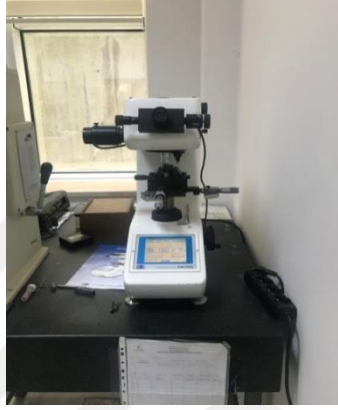
Şekil 4.7. Future-Tech FM-700 mikrosertlik cihazı
