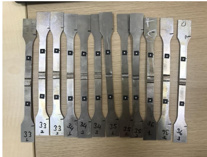
Şekil 4.8. Yaşlandırma işlemi uygulanmış çekme deneyi numuneleri
