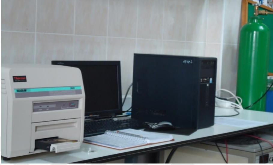
Şekil 3.7. Ölçümlerin alındığı TLD okuyucu sistemi.
