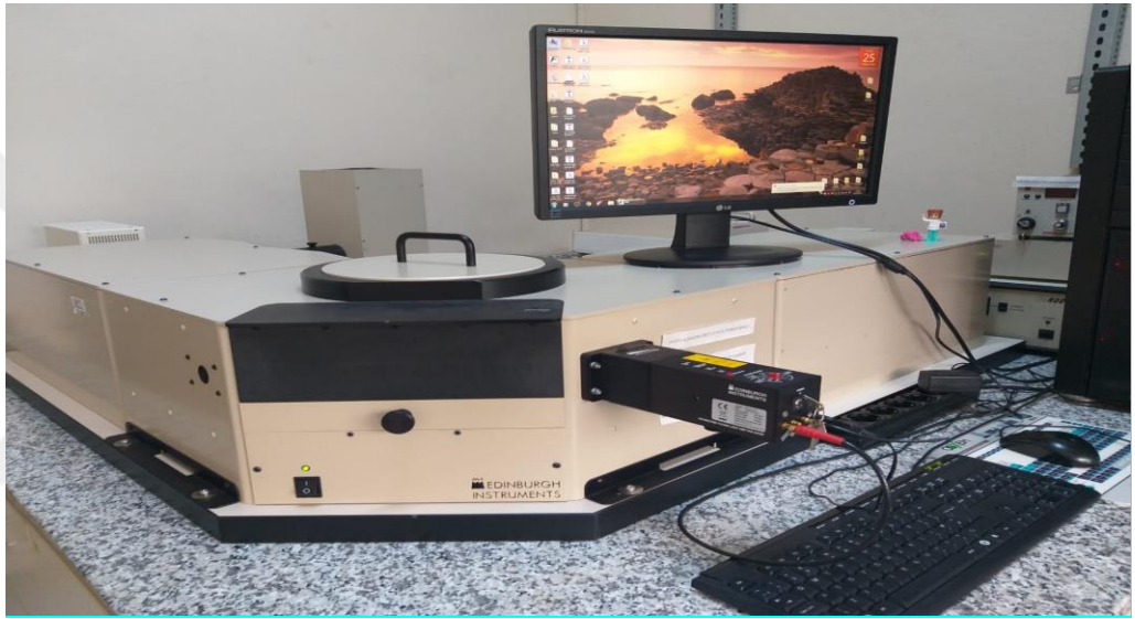
Şekil 3.11. Fluorimetre sistemli fotolüminesans cihazının genel görünümü.
