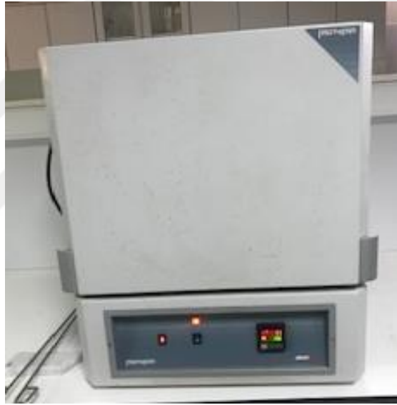
Şekil 3.4. Sentez aşamasında kullanılan kül fırını.
