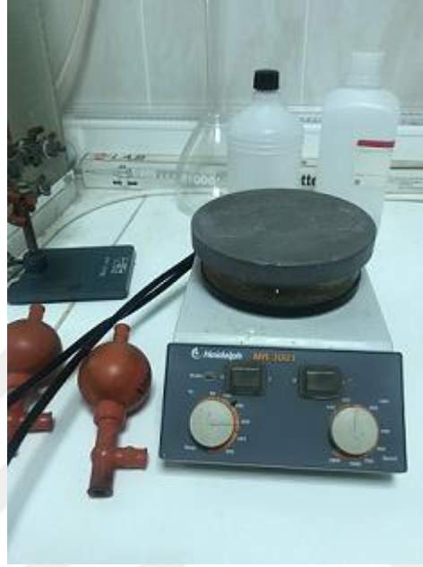
Şekil 3.3. Sentez aşamasında kullanılan manyetik karıştırıcı.
