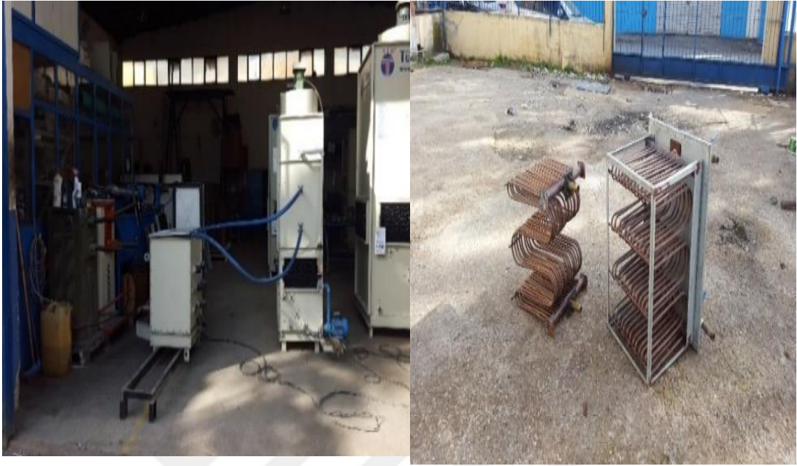
Şekil 5.1. Test cihazı ve harici ısıtma tankı, 6 ve 8 sıralı eşanjörler
