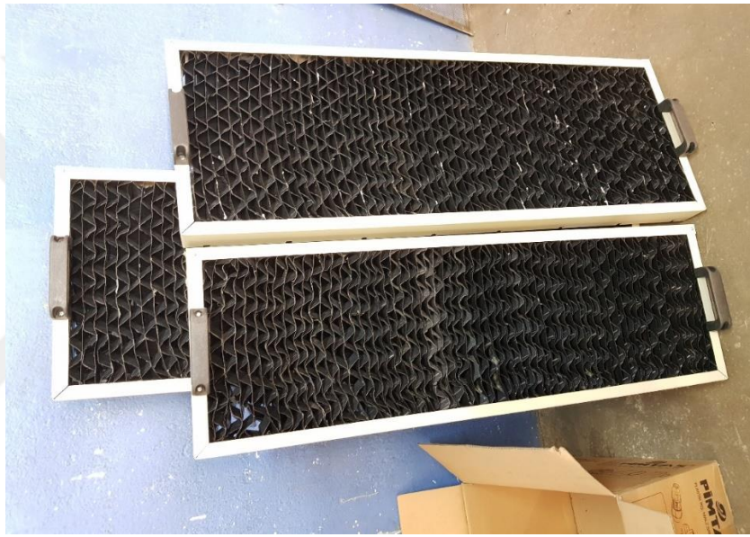
Şekil 3.16. Soğutma kulesi panjurları
