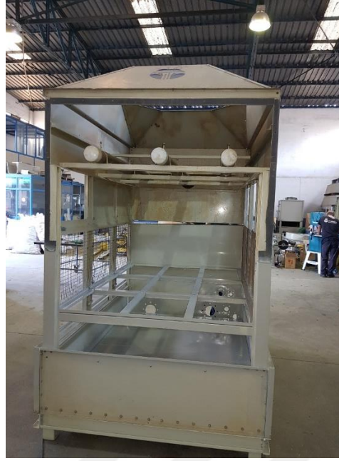
Şekil 3.18. Soğutma kulesinde taşıyıcı yapı
