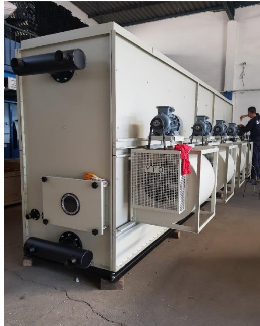
Şekil 3.19. Soğutma kulesinde servis penceresi
