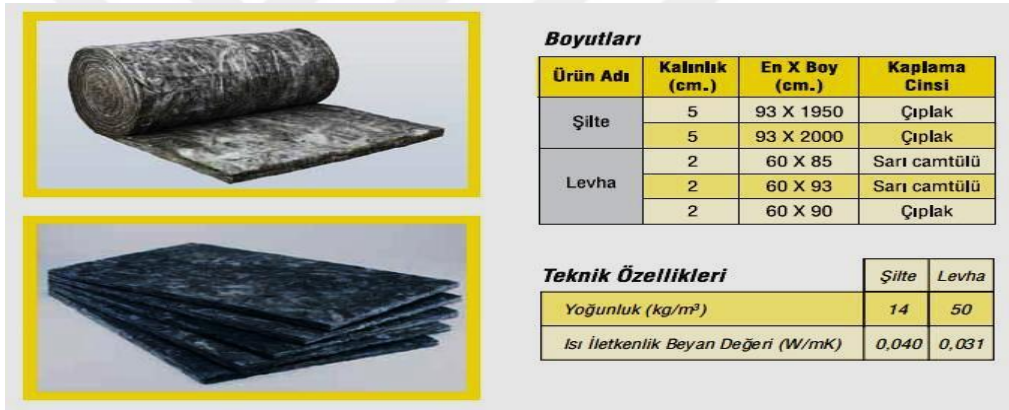
Şekil 2.19. Kollektör şilte ve levhası ve teknik özellikleri [20]
