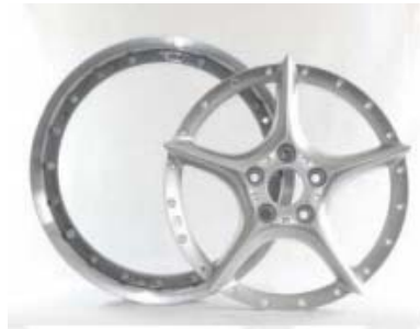
Şekil 2.10: Döküm Kollu Parçalı Jant
