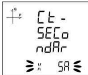
Şekil 3.8. Entes MPR45S akım trafosu sekonder ayarları[19]
