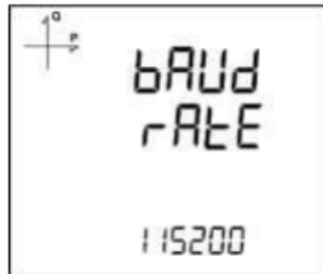
Şekil 3.11. Entes MPR45S modbus haberleşme hızı ayarları [19]
