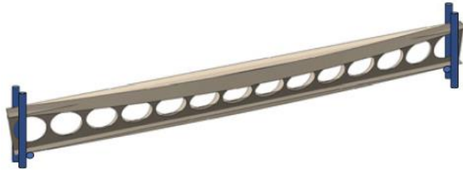
Şekil 5.9. Dairesel Kirişte Yanall Burulmalı Burkulma
