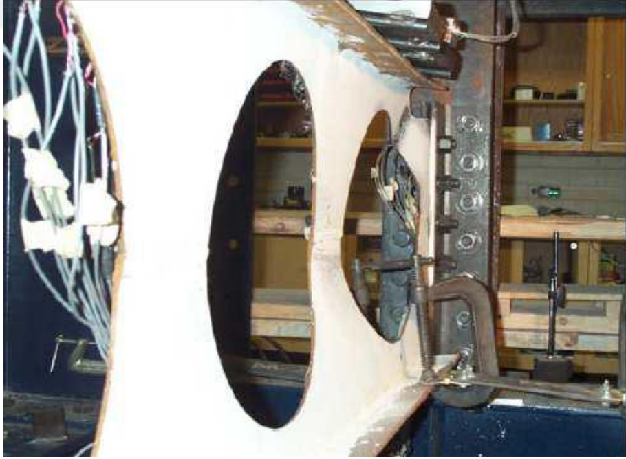
Şekil 5.11. Gövde açıklıklı kirişte gövde burkulması
