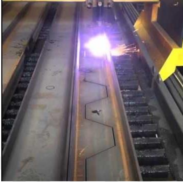
Şekil 5.2 CNC Makine ile Otomatik Kesim
