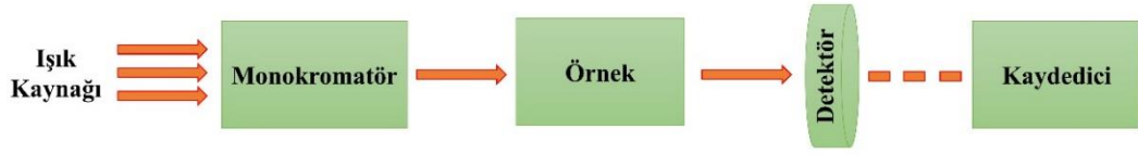
Şekil 3.3. UV spektrometresi şeması (Tek yollu)
