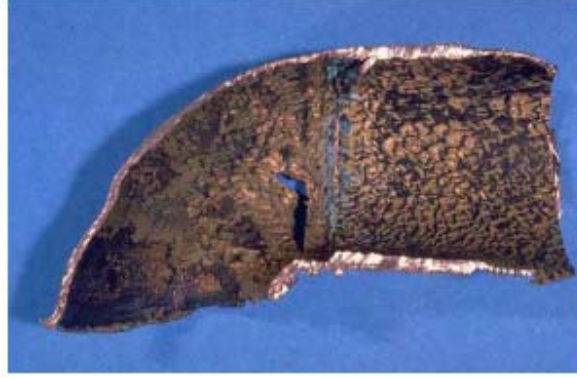
Şekil 2.3. Türbülanslı bir bölgede korozyon erozyonu [16].
