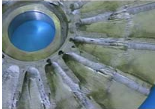
Şekil 2.4. Hastelloy C276 nikel alaşımlı pompa kanadının hidroklorik asit ortamında kavitasyon korozyonu [16].
