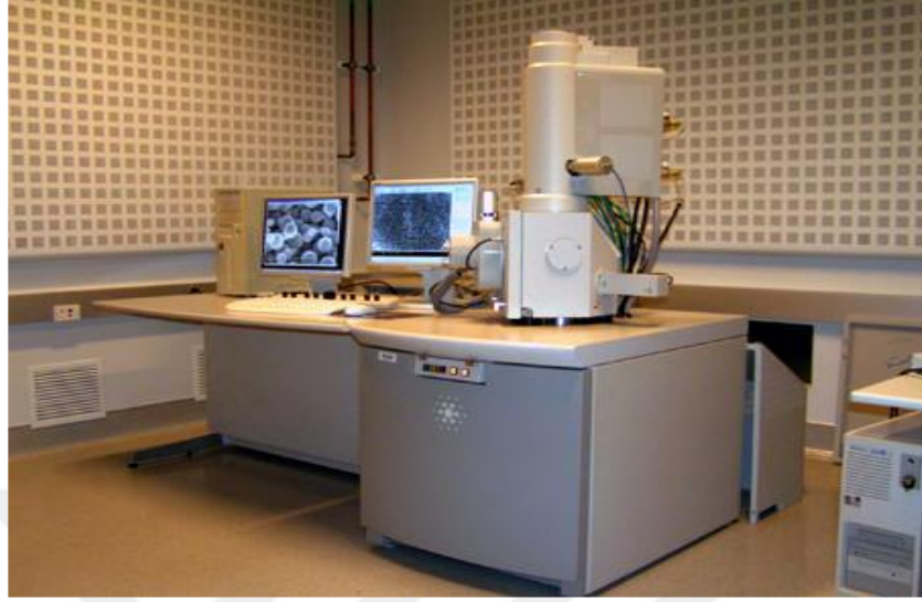
Şekil 6.7. İYTE’de bulunan Phillips XL-30 marka SEM mikroskobu (Url 32)
