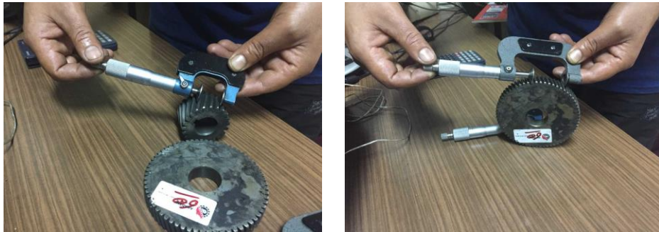
Şekil 3.5. Dişli çarklarda ısıl işlemler sonrası boyut değişimlerinin ölçülmesi
