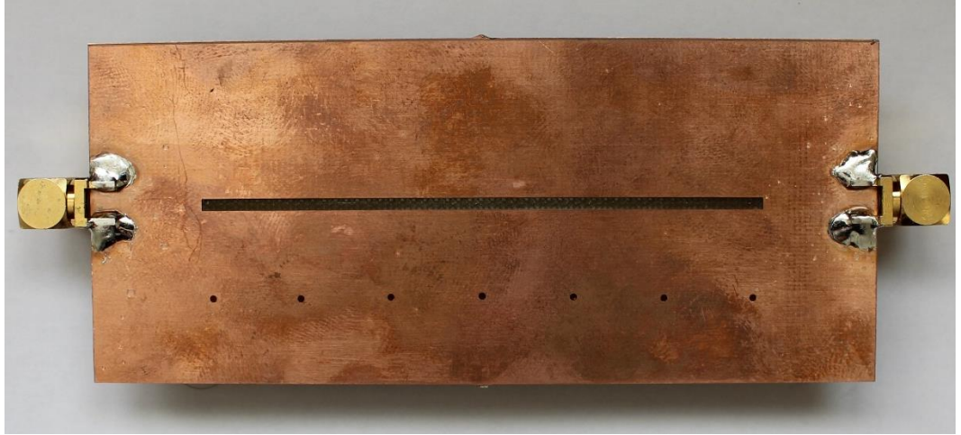
Şekil 5.3. Taban iletkeni kusurlu yapıdaki çift bant Mikroşerit filtrelerin üst yüzeyindeki tasarım.
