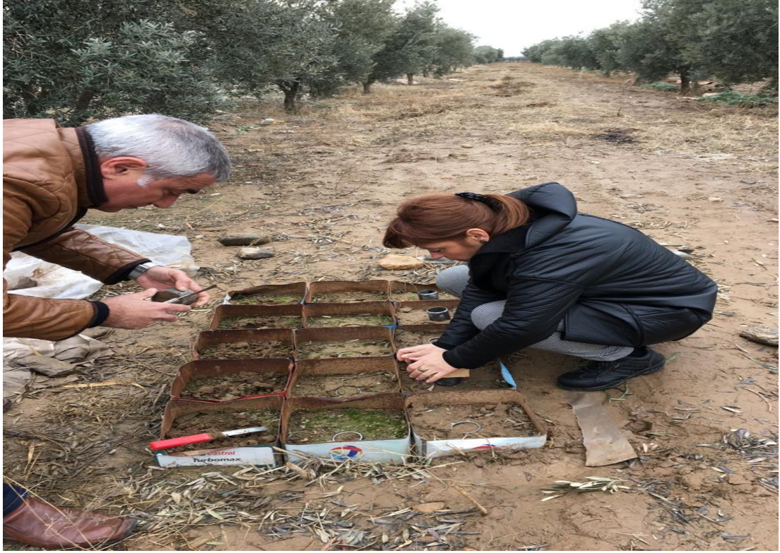
Şekil 3.3. İnkübasyon sonrası bozulmamış toprak örneklerinin alınması
