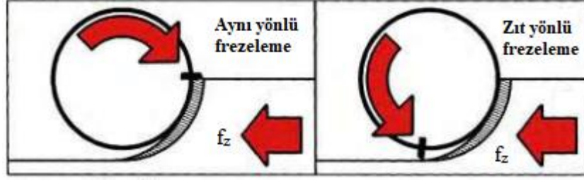
Şekil 2.11. Aynı ve Zıt Yönlü Frezeleme [63].
