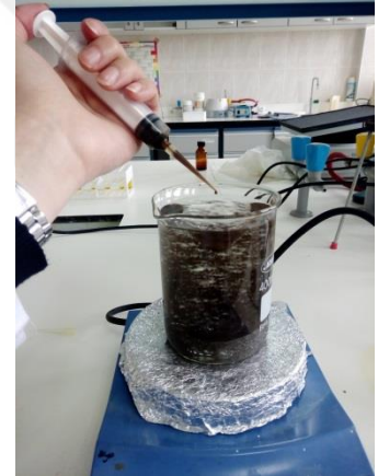
Şekil 3. 2. CS-Fe 3 O 4 Boncuklarının Oluşturulmasının Şematik Gösterimi
