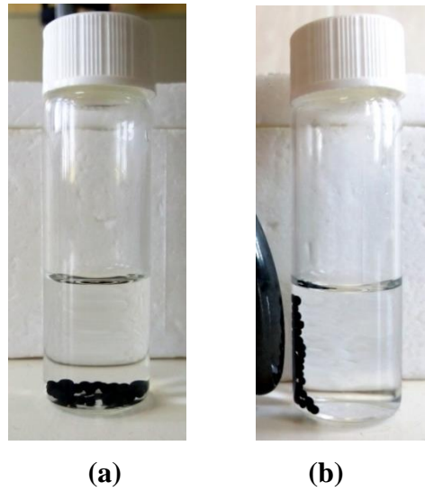
Şekil 4. 9. CS- Fe_3O_4 boncuklarının dış manyetik alana maruz kalmadan önceki(a) ve sonraki(b) durumu
