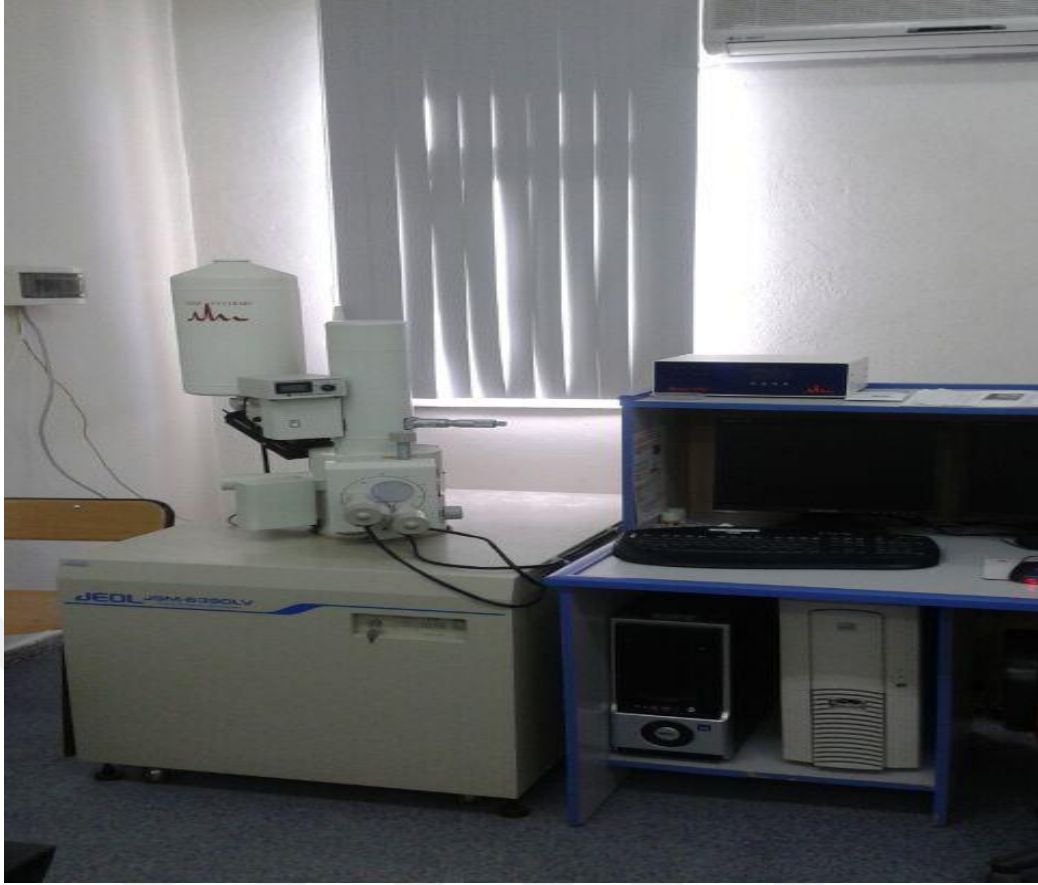
Şekil 3.2.5.1: JEOL JSM-6390LV marka Taramalı Elektron Mikroskobu.
