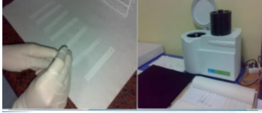
Şekil 3.2 TLC ( örnek damlatma ve yürütme işlemleri) Perkin Elmer Cyclone Plus Storage Phosphor System cihazı
