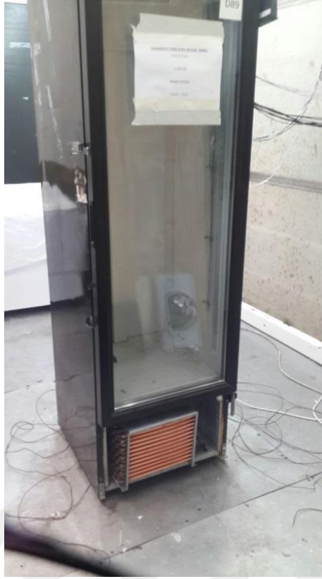
Şekil 7.1. Test standında kullanılan dairesel kesitli kondenser sahip bir soğutucu
