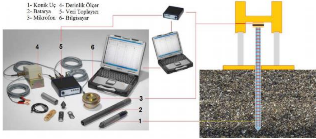
Şekil 2.13. Akustik CPT ekipmanları
