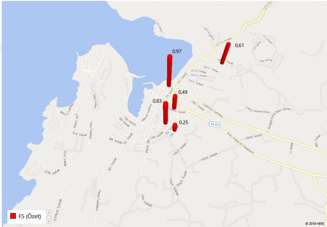
Şekil 4.3. Tahmini verilere göre sıvılaşma analizinde riskli çıkan bölgeler
