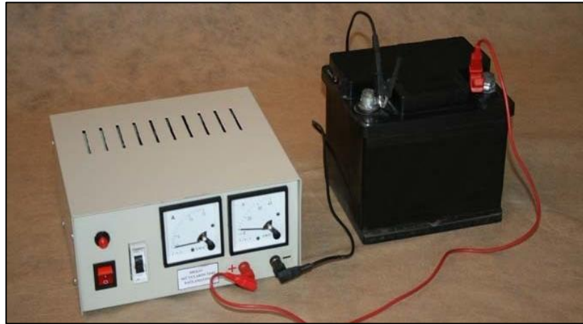
Şekil 2.14. DC güç kaynağı ile şarj edilen akü bağlantısı
