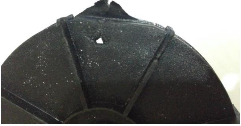
Şekil 2. 45. Parça İçinde Boşluklar [3]
