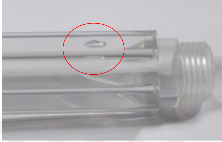
Şekil 2. 36. Yüzeyde Görülen Hava Kabarcıkları [54]
