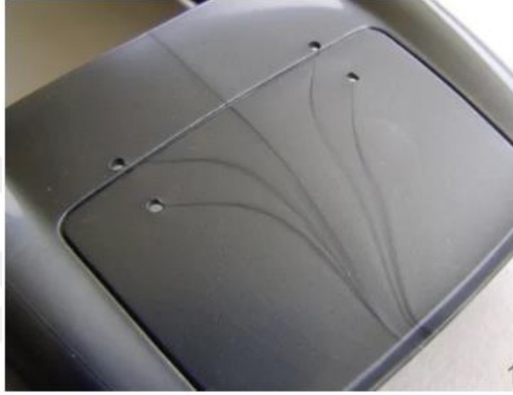
Şekil 2. 37. Ürün Yüzeyinde Görülen Akış İzi [55]
