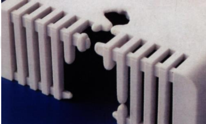
Şekil 2. 43. Tam Dolmamış Parça [19]
