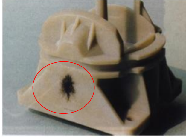
Şekil 2. 38. Parçada Görülen Yanık İzi [56]
