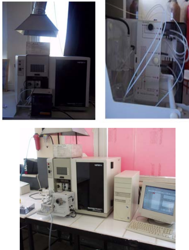
Şekil 3.1. Arsenik Analizinin Yapıldığı Atomik Absorpsiyon Spektrofotometresi ve Sürekli Akış Hidrür Sistemi
