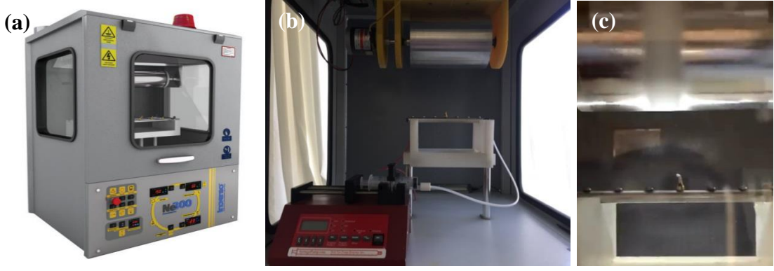
Şekil 3.2. Deneşlerde kullanılan elektroęirme cihazının (a) dıř ve (b) i unite grntleri, (c) elektroęirme iřlemi sırasında ekilmiř bir fotoęraf.
