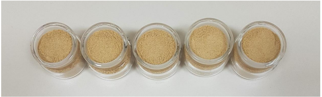
Şekil 4.32 Çorba tozu fotoğrafları soldan sağa doğru; %65-2 devir-75psi, %65-1 devir-85psi, %65-3 devir-85psi, %65-2 devir-95psi
