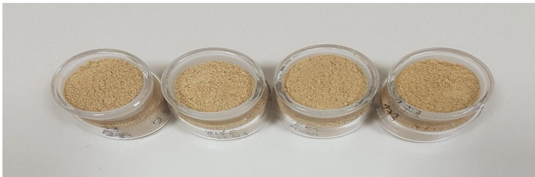
Şekil 4.29 Çorba tozu fotoğrafları soldan sağa doğru; %45-2 devir-75psi, %45-1 devir-85psi, %45-3 devir-85psi, %45-2 devir-95psi
