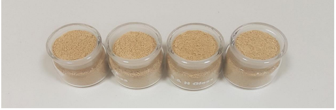
Şekil 4.30 Çorba tozu fotoğrafları soldan sağa doğru; %55-1 devir-75 psi, %55-3 devir-75psi, %55-2 devir-85psi, %55-2 devir-85psi (a)
