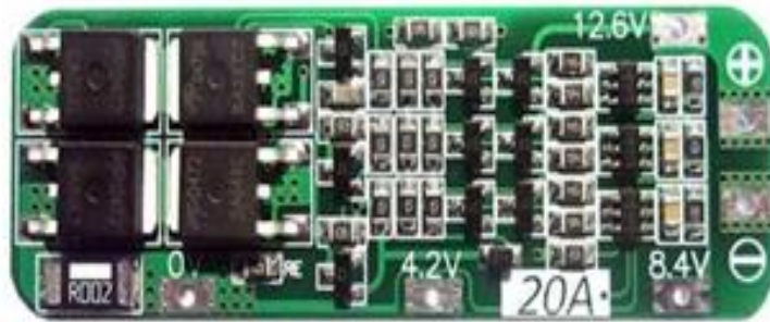
Şekil 3.10. 3s LION pil BMS şarj kiti
