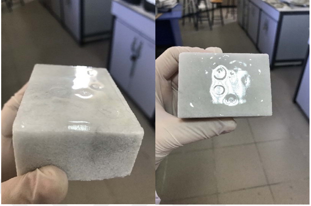
Şekil 4.2. Mermerin kaplama yapıldıktan sonraki görüntüsü
