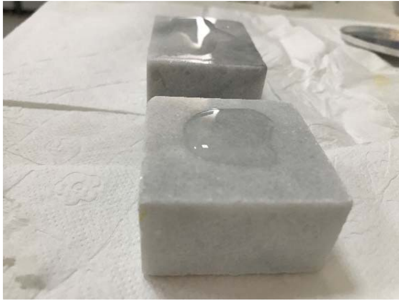
Şekil 4.28. Kaplama yapılan mermerin üzerine NaOH damlatıldıktan sonraki görüntüsü
