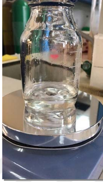
Şekil 3.4. 1 mol H 2 O’nun (0,1M HCl) Glymo ile reaksiyon düzeneği
