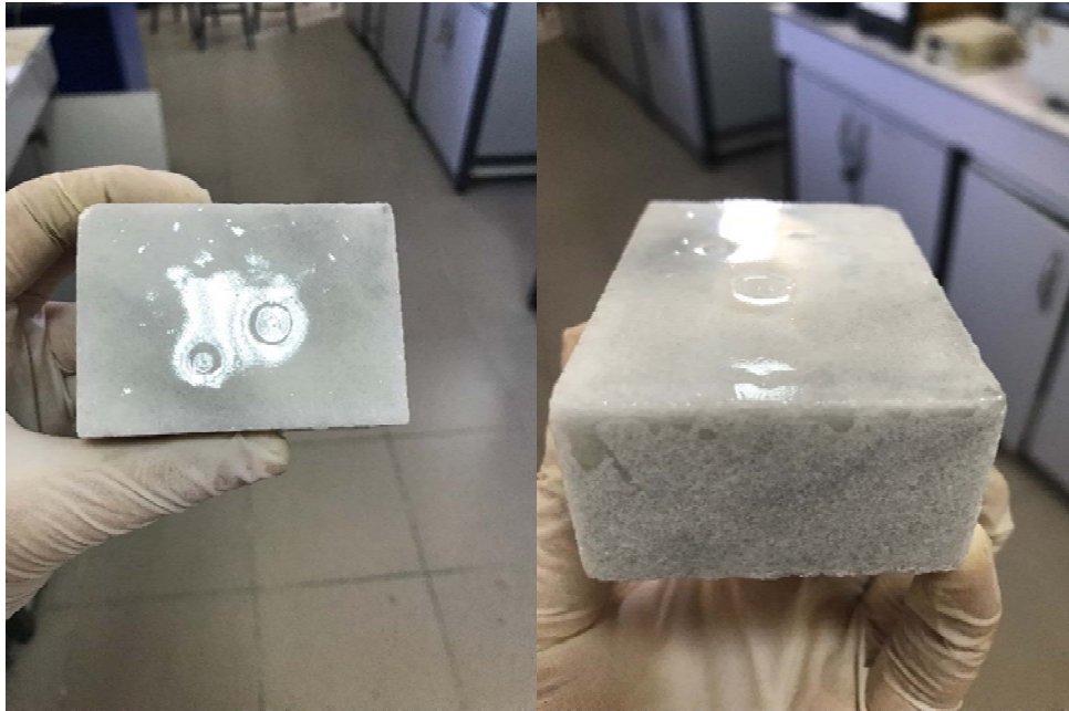
Şekil 4.26. Mermerin kaplama yapıldıktan sonraki görüntüsü
