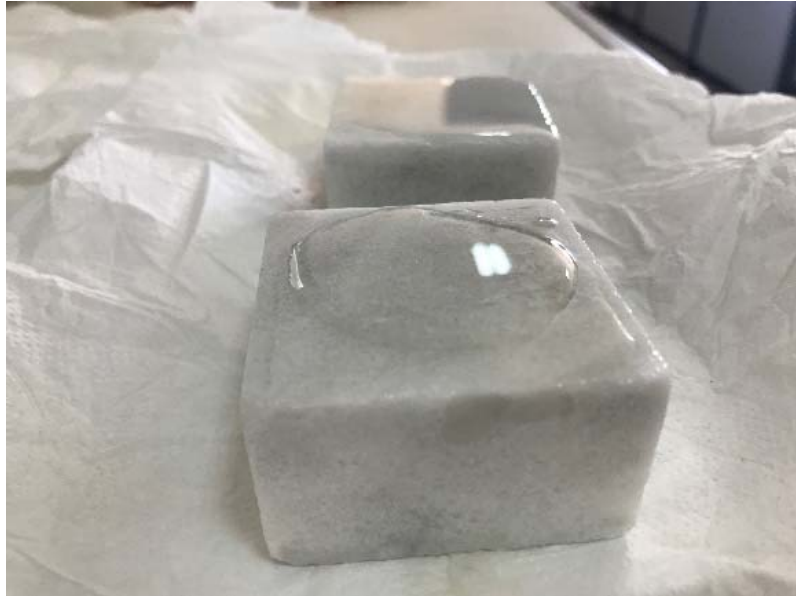
Şekil 4.10. Kapsama yapılan mermerin üzerine \text{HNO}_3 damlatıldıktan sonraki görüntüsü
