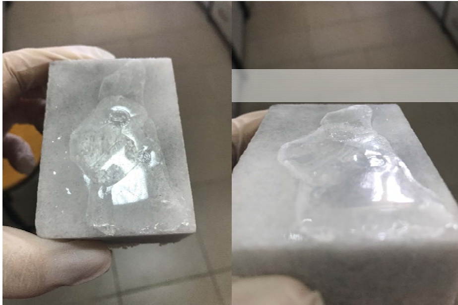
Şekil 4.30. Kaplama yapılan mermerin üzerine damlatılan NaOH' in görüntüsü
