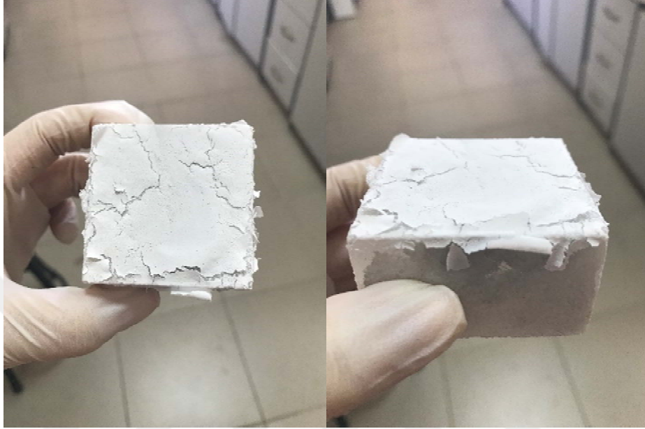
Şekil 4.23. Kaplama yapılmayan mermerin üzerine damlatılan H 2 SO 4 ' in görüntüsü
