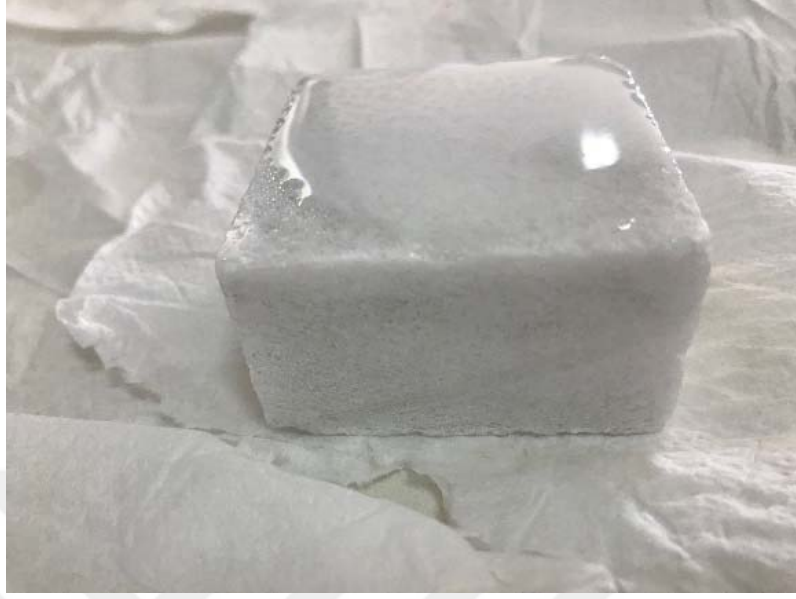
Şekil 4.9. Kapsama yapılmayan mermerin üzerine \text{HNO}_3 damlatıldıktan sonraki görüntüsü
