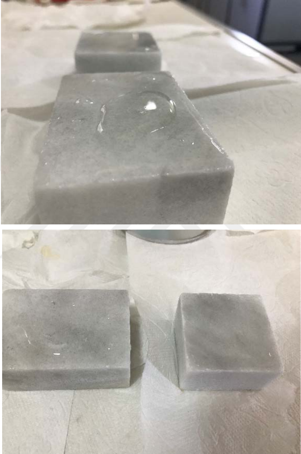
Şekil 4.4. Kplama yapılmayan(sol) kplama yapılan (sağ) mermerin üzerine HCl damlatıldıktan sonraki görüntüsü
