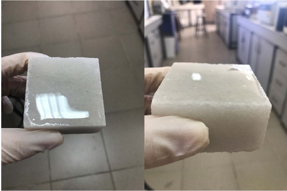
Şekil 4.12. Kaplama yapılan mermerin üzerine damlatılan HNO 3 ' in görüntüsü
