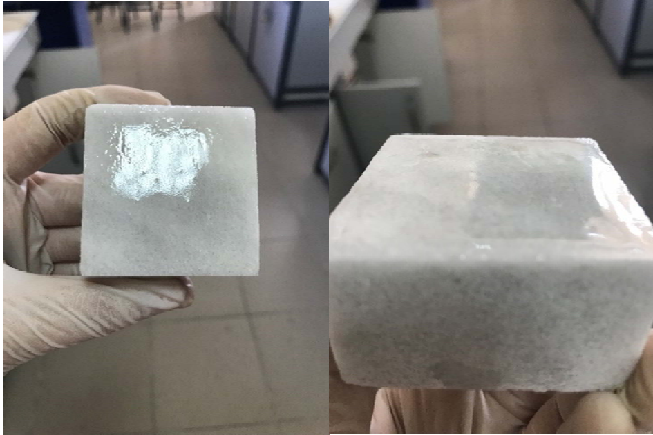
Şekil 4.8. Mermerin kaplama yapıldıktan sonraki görüntüsü
