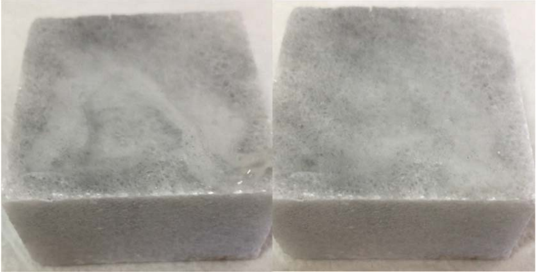
Şekil 4.3. Kaplama yapılmayan mermere HCl ilavesinden sonraki görüntüsü
