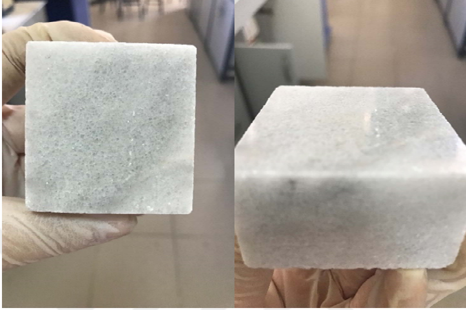
Şekil 4.13. Mermerin kaplama yapılmadan önceki görüntüsü
