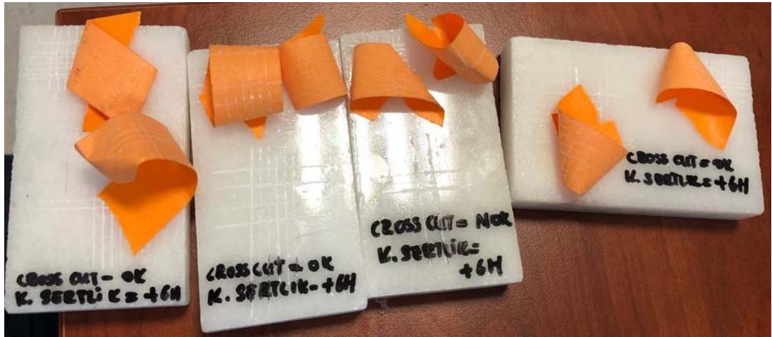
Şekil 4.31. Kaplanmış Mermerin Cross Cut ve Kalem Sertliđi Testinin Görüntüsü
