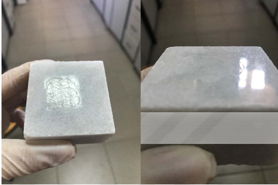
Şekil 4.29. Kaplama yapılmayan mermerin üzerine damlatılan NaOH' in görüntüsü
