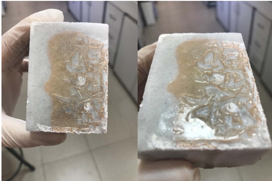
Şekil 4.24. Kaplama yapılan mermerin üzerine damlatılan H 2 SO 4 ' in görüntüsü
