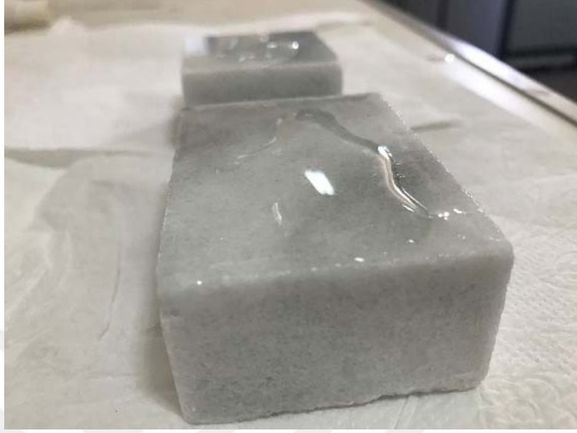
Şekil 4.27. Kaplama yapılmayan mermerin üzerine NaOH damlatıldıktan sonraki görüntüsü
