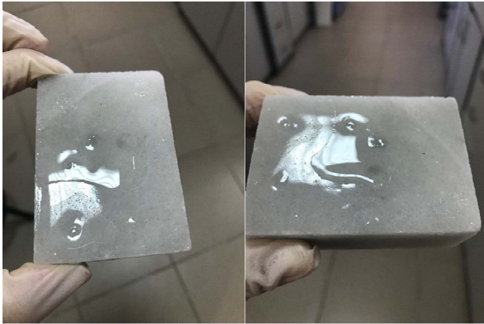
Şekil 4.6. Kaplama yapılan mermerin üzerine damlatılan HCl' in görüntüsü
