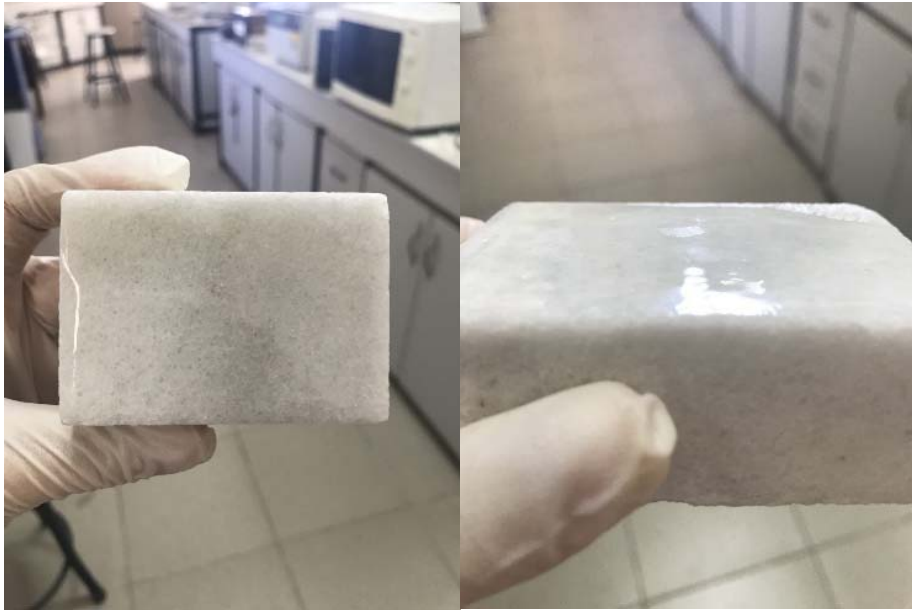
Şekil 4.18. Kaplama yapılan mermerin üzerine damlatılan HNO 3 ' in görüntüsü
