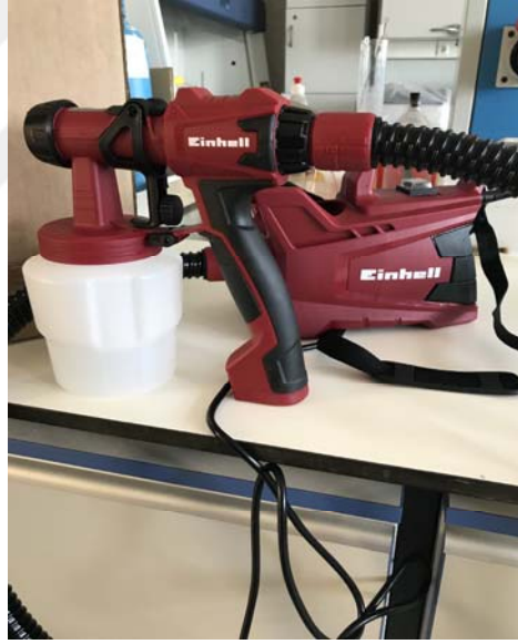
Şekil 3.3. Sprey kaplamanın yapıldığı elektrikli boya tabancası
