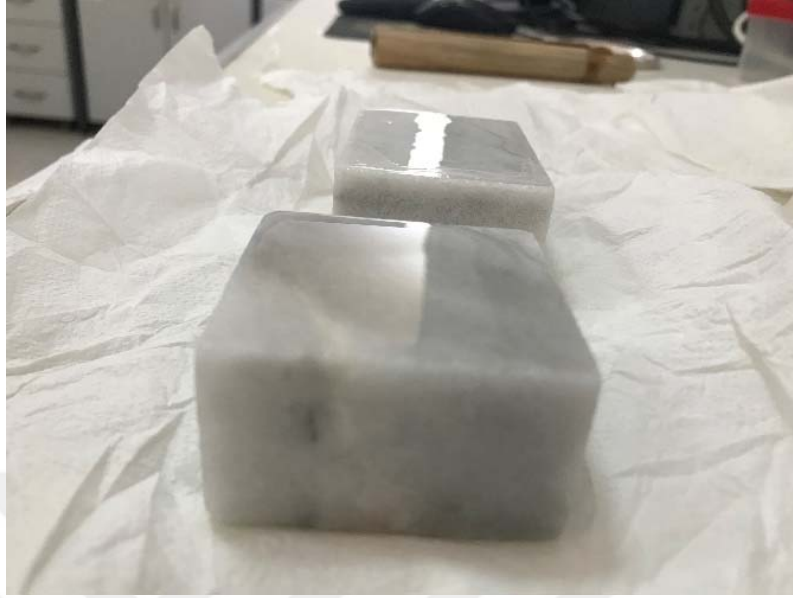
Şekil 4.15. Kaplama yapılmayan mermerin üzerine \text{CH}_3\text{COOH} damlatıldıktan sonraki görüntüsü
