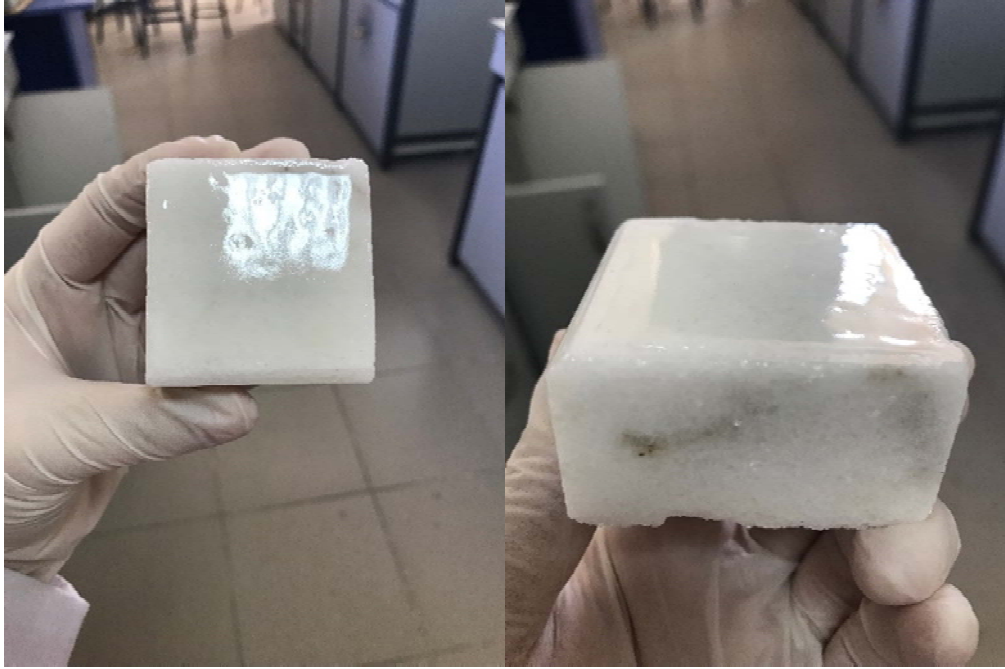
Şekil 4.20. Mermerin kaplama yapıldıktan sonraki görüntüsü
