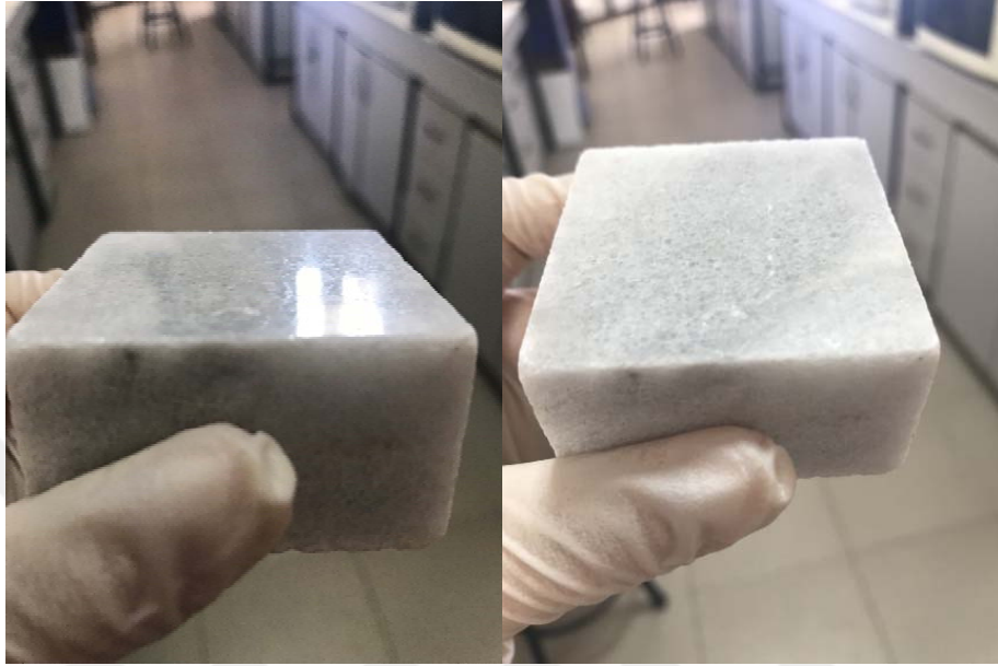
Şekil 4.17. Kaplama yapılmayan mermerin üzerine damlatılan CH 3 COOH' in görüntüsü
