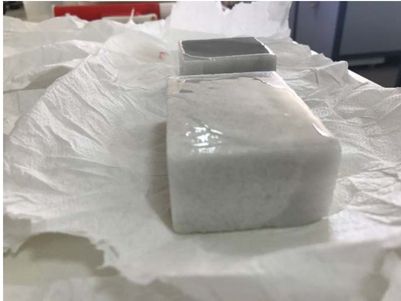
Şekil 4.16. Kaplama yapılan mermerin üzerine \text{CH}_3\text{COOH} damlatıldıktan sonraki görüntüsü
