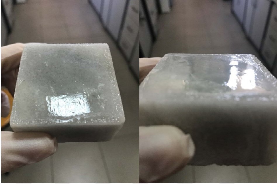
Şekil 4.11. Kaplama yapılmayan mermerin üzerine damlatılan HNO 3 ' in görüntüsü
