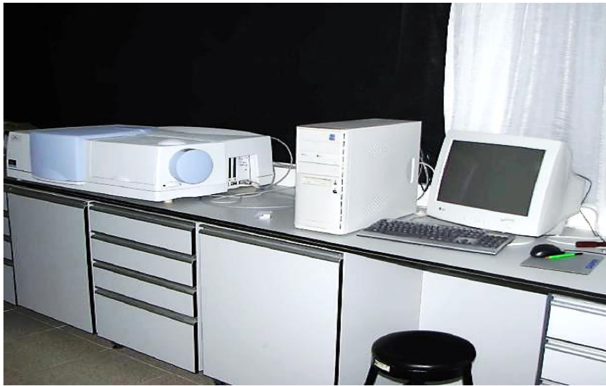
Şekil 4.5. Manisa Celal Bayar Üniversitesi Lüminesans Araştırma Laboratuvarında bulunan Perkin Elmer Lambda 950 UV/VIS/NIR Spektrofotometre sistemi
