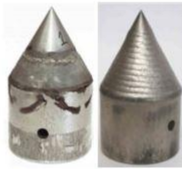
Şekil 2.13. Buhar valfi yüksek sıcaklıkta erozif etkilere maruz kalarak önemli oranda aşınmış, sonrasında kobalt esaslı süper alaşım ile lazer kaplama yapılarak tamir edilmiş hali [19].
