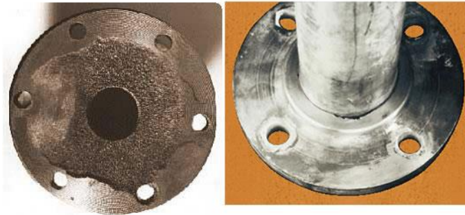
Şekil 2.28. Korozyon Aşınma örnekleri [38].
