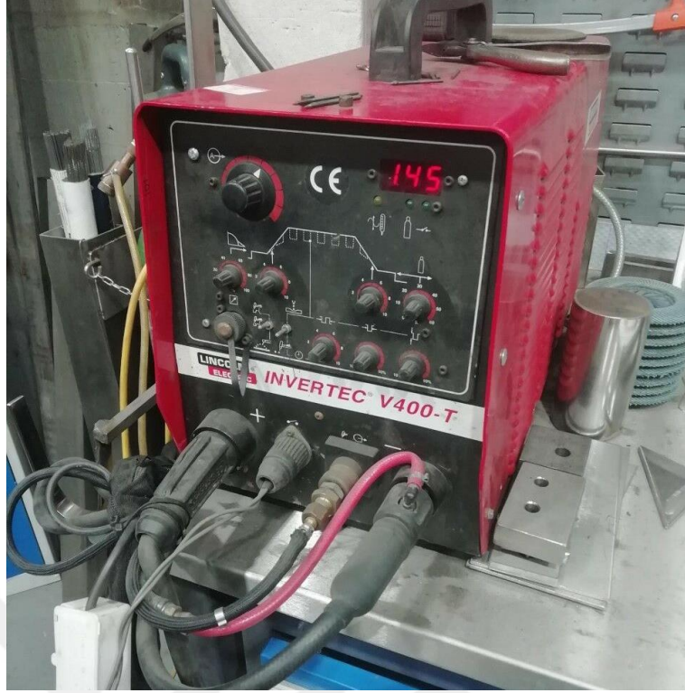
Şekil 3. 2. TIG Kaynak cihazı
