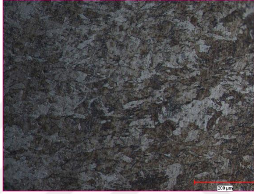
Şekil 4.53. 50CrV4 Çeliği TIG kaynağı kaynak metali mikroyapı görüntüsü
