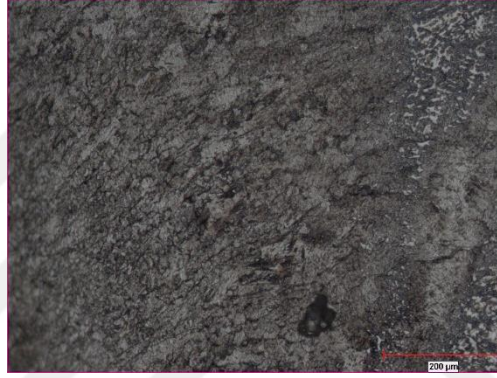
Şekil 4.40. 50CrMo4 Çeliği TIG kaynağı ITAB mikroyapı görüntüsü
