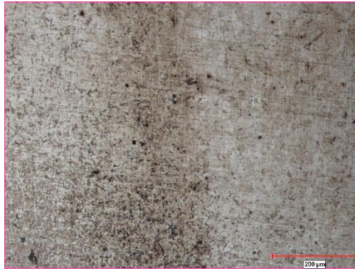
Şekil 4.50. C22 Çeliği Ark kaynağı kaynak metali mikroyapı görüntüsü
