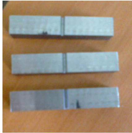
Şekil 3. 11. V çentik açılan numuneler
