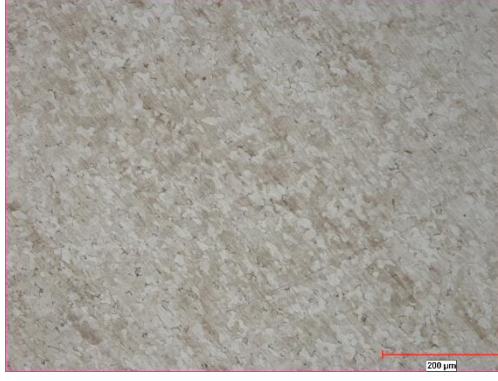
Şekil 4.52. 50CrV4 Çeliği ana metal mikroyapı görüntüsü
