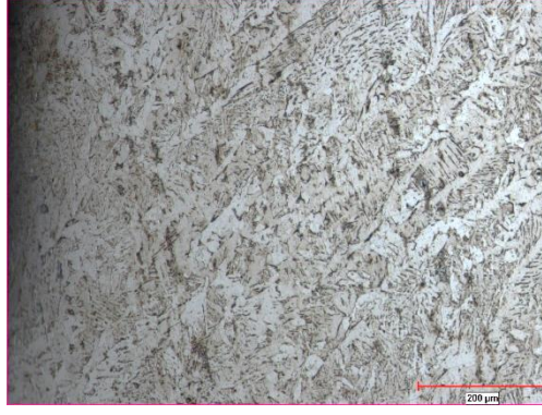
Şekil 4.55. 50CrV4 Çeliği MIG kaynağı kaynak metali mikroyapı görüntüsü
