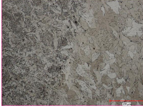
Şekil 4.58. 50CrV4 Çeliği Ark kaynağı itab mikroyapı görüntüsü
