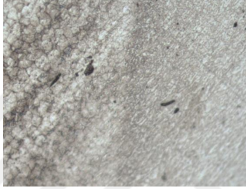
Şekil 4.44. 50CrMo4 Çeliği Ark kaynağı ITAB mikroyapı görüntüsü
