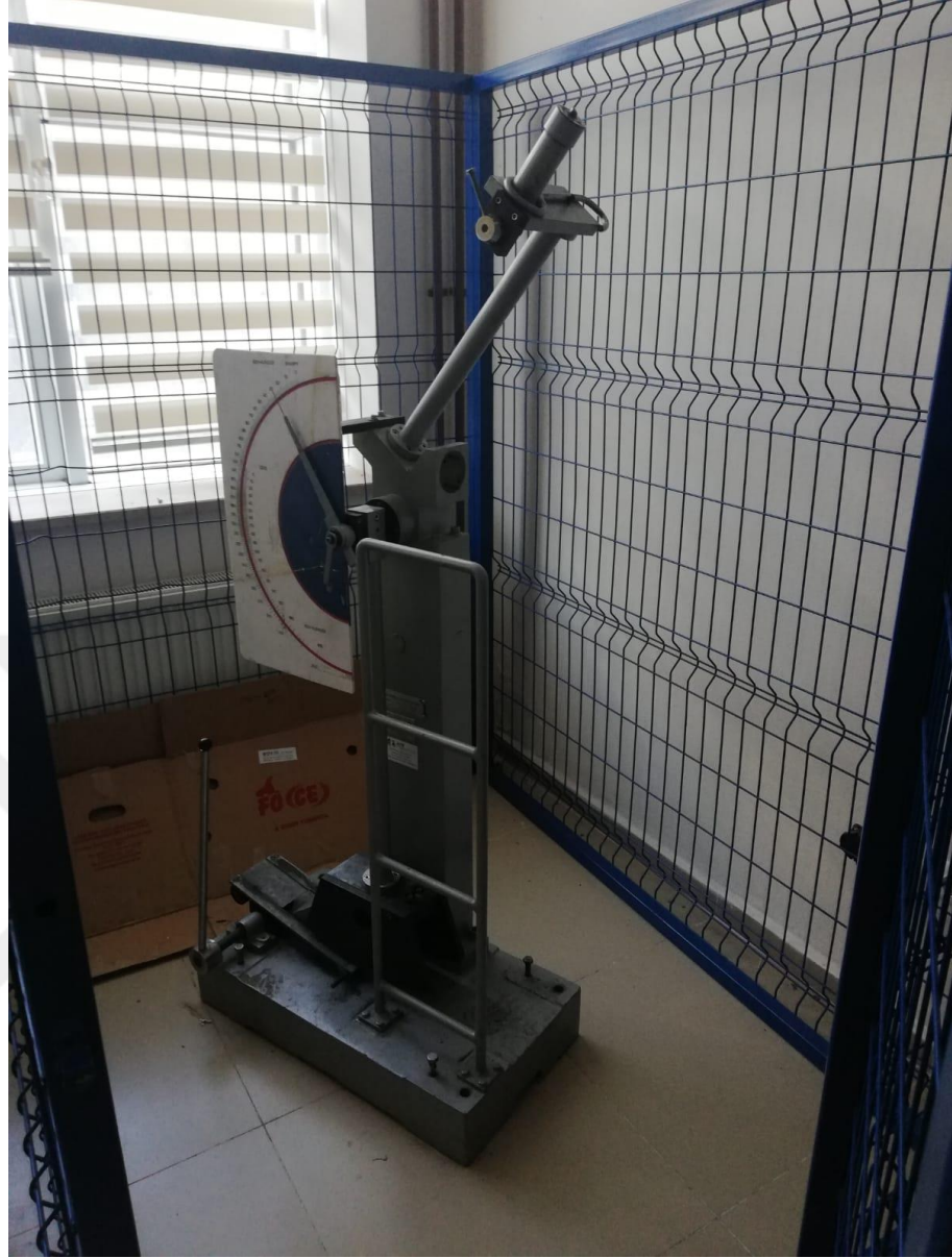
Şekil 3. 4. Çentik darbe deneyi cihazı
