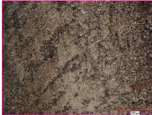
Şekil 4.39. 50CrMo4 Çeliği TIG kaynağı kaynak metali mikroyapı görüntüsü
