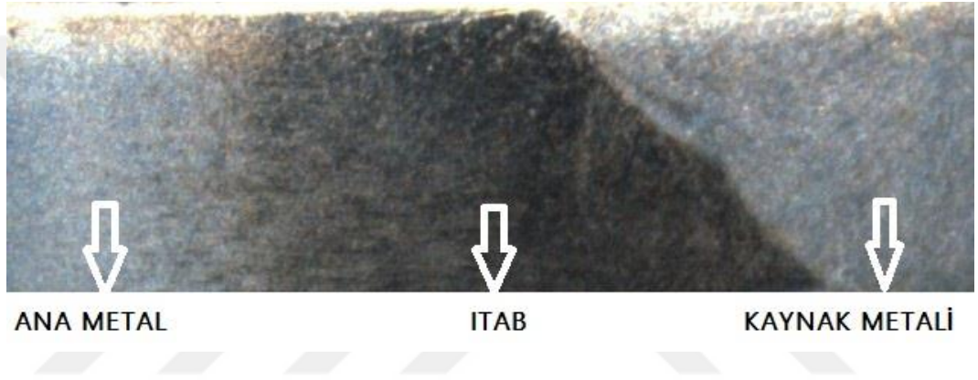
Şekil 4.32. C22 Çeliği TIG kaynağı stereo mikroskop görüntüsü
