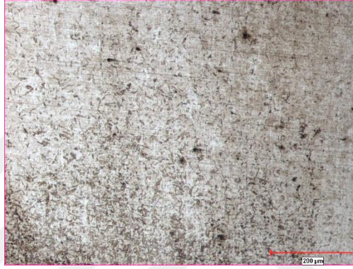
Şekil 4.50. C22 Çeliği Ark kaynağı kaynak metali mikroyapı görüntüsü
