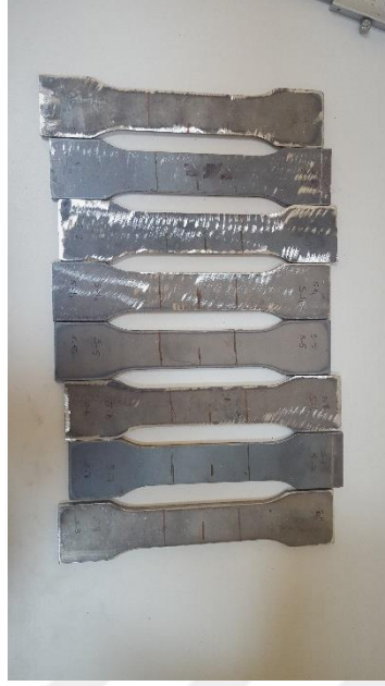
Şekil 3. 10. 50CrV4 çeliği çekme deneyi uygulaması öncesi
