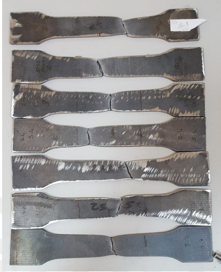
Şekil 4.4. 50CrV4 Çeliği çekme deneyi sonrası
