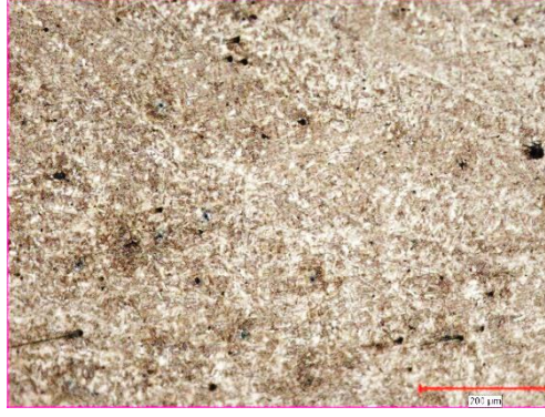
Şekil 4.46. C22 Çeliği TIG kaynağı kaynak metali mikroyapı görüntüsü
