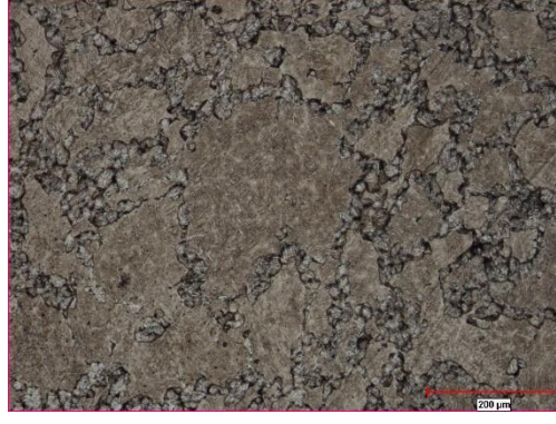
Şekil 4.43. 50CrMo4 Çeliği Ark kaynağı kaynak metali mikroyapı görüntüsü
