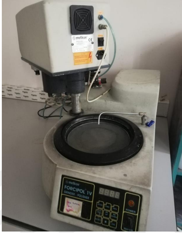
Şekil 3. 3. Numune zımparalama ve parlatma cihazı
