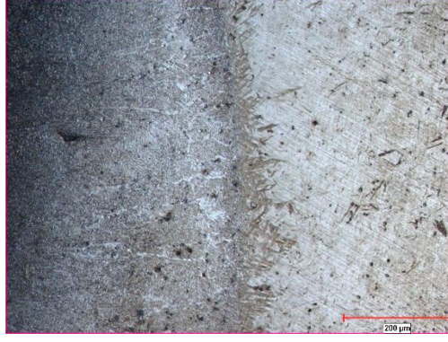
Şekil 4.49. C22 Çeliği MIG kaynağı ITAB mikroyapı görüntüsü
