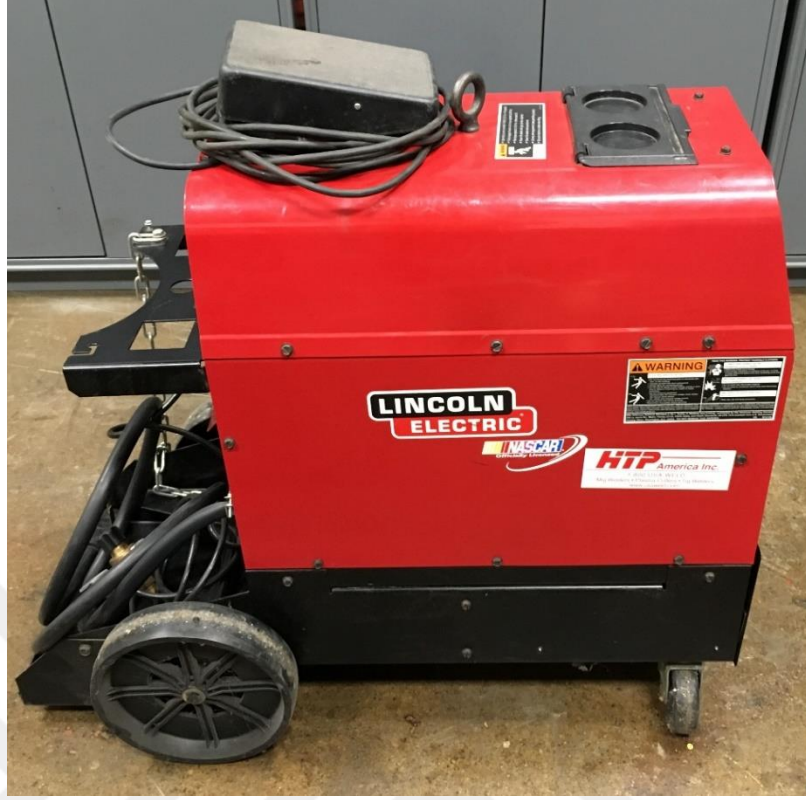
Şekil 3. 1. MIG/MAG Kaynak cihazı
