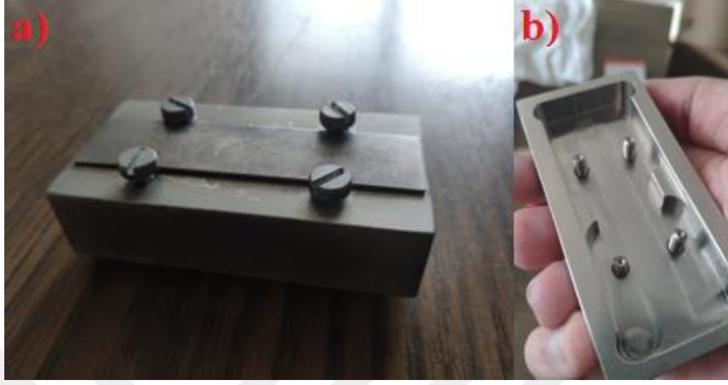
Şekil 7.21. a) Almen şeriti dövme aparatı, b) Almen şiddeti ölçüm aparatı
