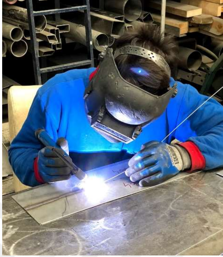
Şekil 3.5. TIG Kaynağın Operatör Tarafından Gerçekleştirilmesi
