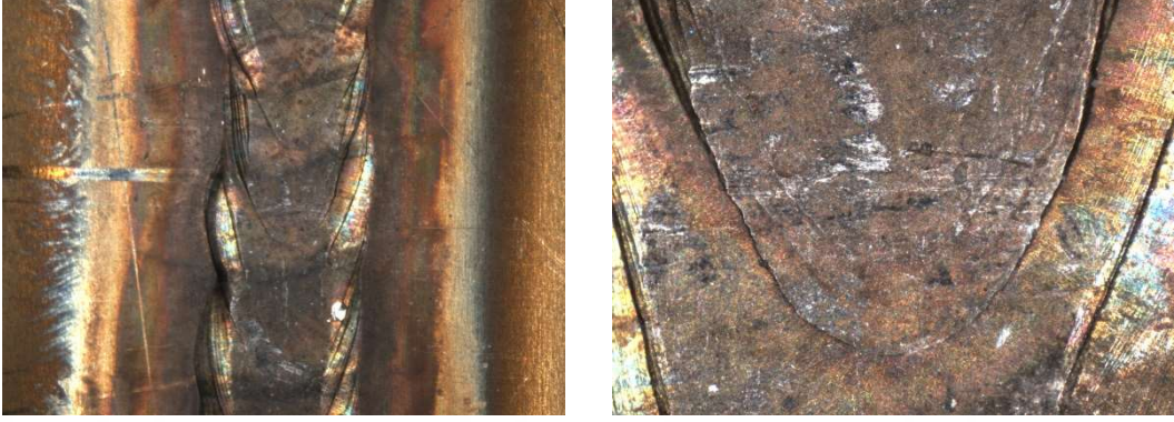
Şekil 4.14. TIG Kaynağı İle Birleştirilmiş Ve Eğme Testi Uygulanmış Numunenin Kaynak Bölgesi Fotoğrafı
