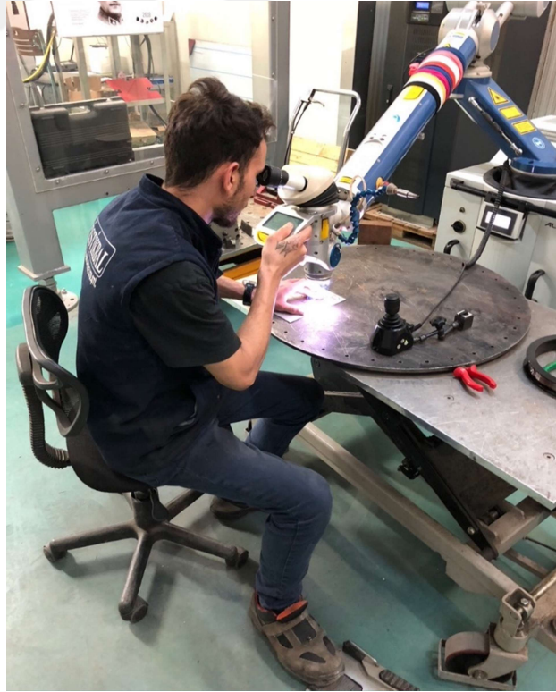
Şekil 3.3. Lazer Kaynağın Operatör Tarafından Gerçekleştirilmesi
