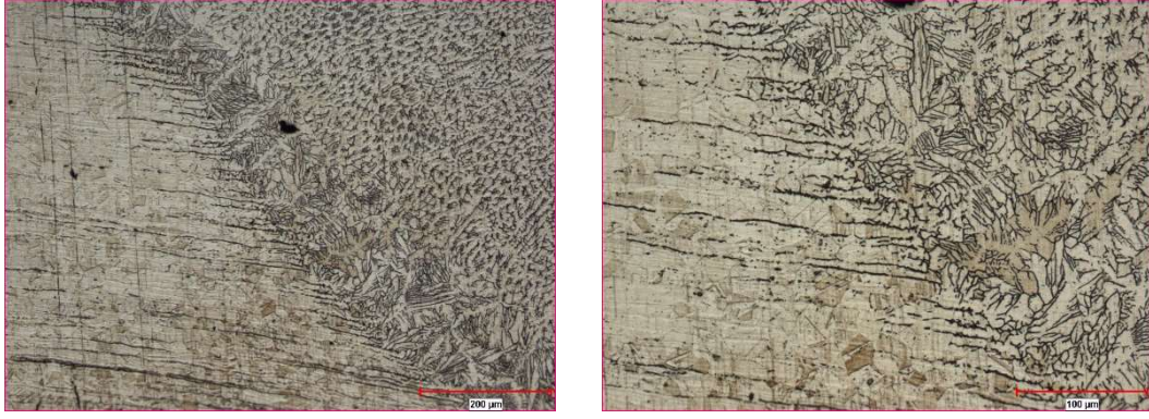
Şekil 4.5. TİG Kaynağı İle Birleştirilmiş Numuneye Ait Geçiş Bölgesi
