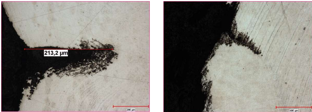
Şekil 4.15. TİG Kaynağı İle Birleştirilmiş Ve 168 Saat Süresince Çözeltide Bekletilmiş Hassaslaştırılmamış Numuneye Ait Çatlak Oluşumu
