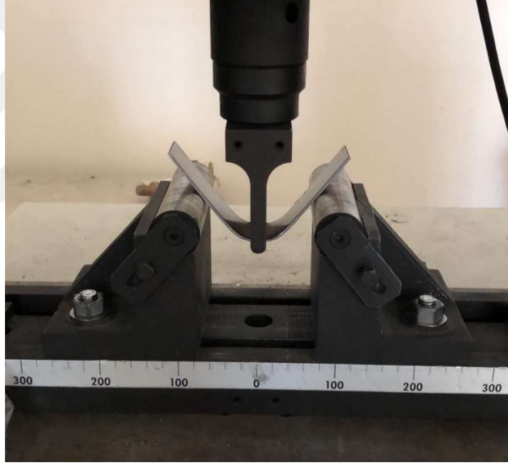
Şekil 3.16. Numune Üzerinde Eğme Testinin Uygulanması
