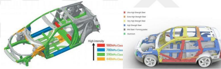
Şekil 2. Araçların farklı bölümlerinde kullanılan çeliklere ait sınıflandırma
