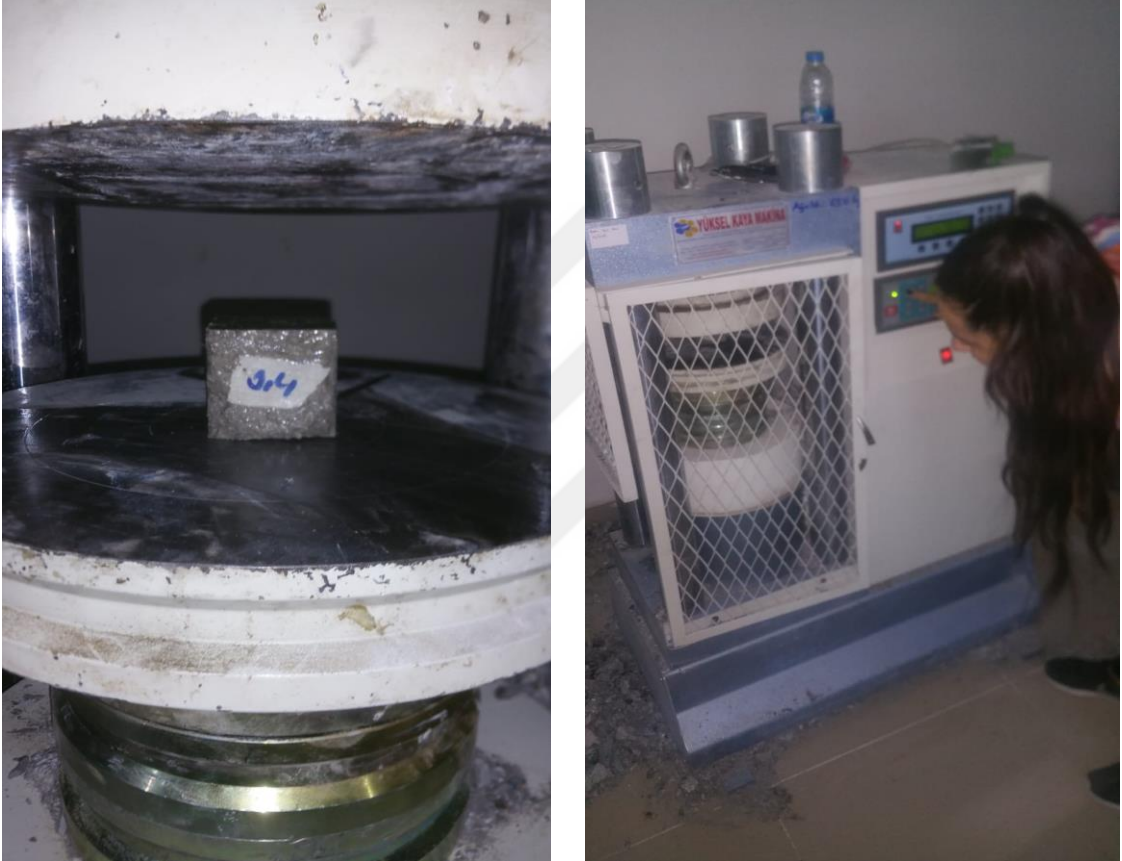
Şekil 3.4. Beton numunelerinin basınç dayanımı tayini
