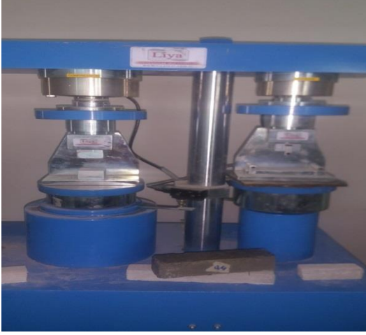
Şekil 3.5. Beton numunelerin eğilme dayanımı tayini
