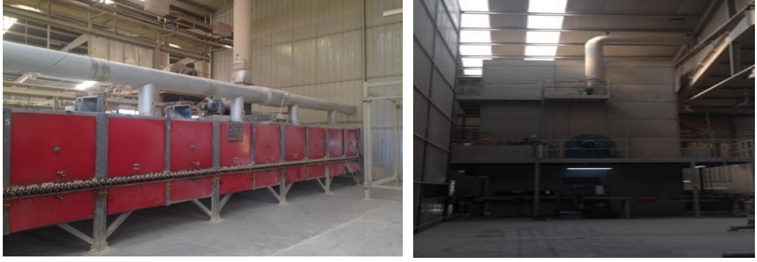
Şekil 2.3. Seramik kurutma işleminde kullanılan yatay ve dikey kurutucular
