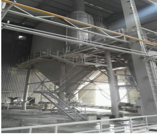
Şekil 2.2. Püskürtmeli kurutucu ve kurutucudan çıkan granül
