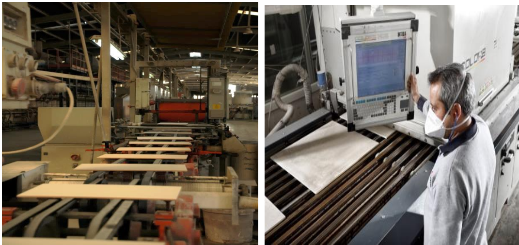
Şekil 2.4. Sırlama bantları ve baskı aşamaları
