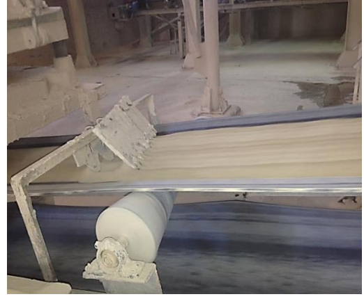
Şekil 2.2. Püskürtmeli kurutucu ve kurutucudan çıkan granül
