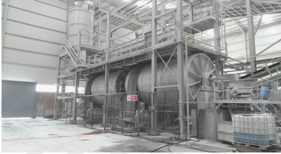
Şekil 2.1. Seramik üretiminde kullanılan bilyalı değirmenler
