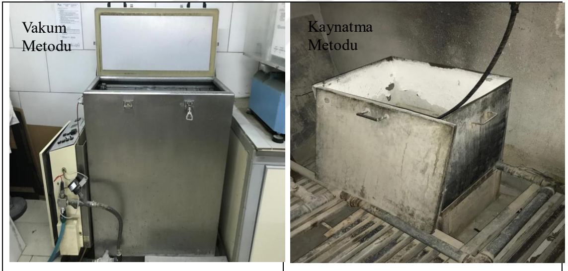
Şekil 2.6. Su emme tayini için kullanılan cihazlar
