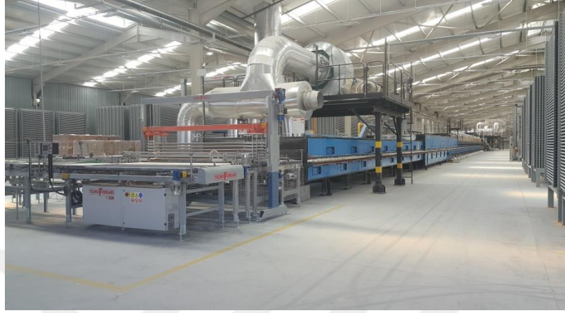
Şekil 2.5. Seramik üretiminde kullanılan yüksek sıcaklık fırın örneği
