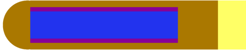
Şekil 4.60. M19, HDR kaynak modelinin EGS-mg veri tabanında bulunan 3-boyutlu tasarımının dik kesit görüntüsü.
