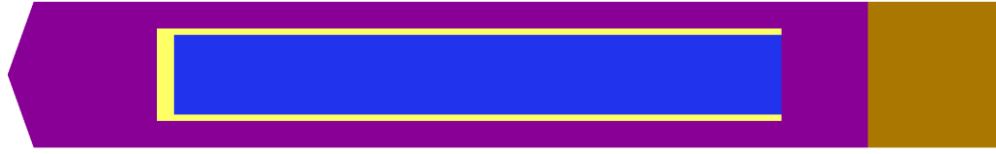
Şekil 4.29. GammaMed 12i, HDR brakiterapi kaynak modelinin EGS-mg veri tabanında bulunan 3-boyutlu tasarımının dik kesit görüntüsü.
